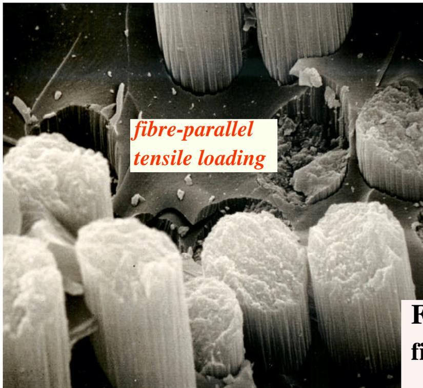
**FF1 tensile fibre fracture (pull-out)**
