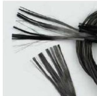
Bild 2.1 Carbonfilamente
