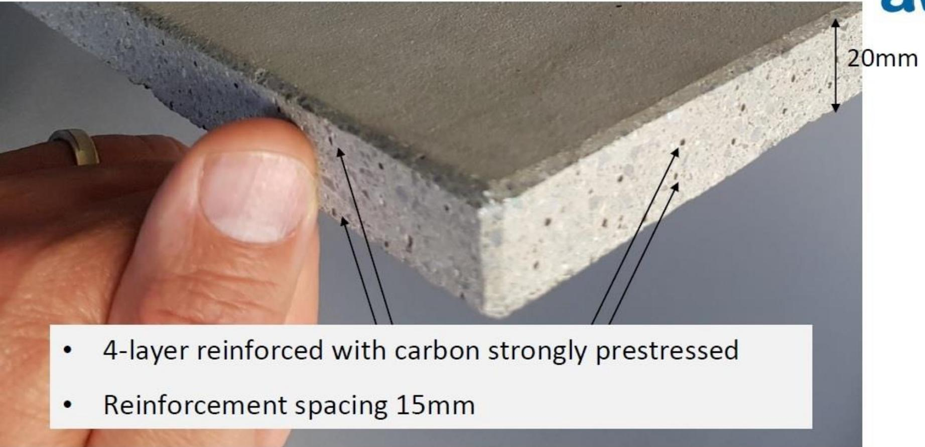
**Vorspannung im Spannbett: Für ebene Platten gute Idee für Serienprodukt**
