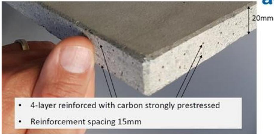
Vorspannung im Spannbett: Für ebene Platten gute Idee für Serienprodukt
