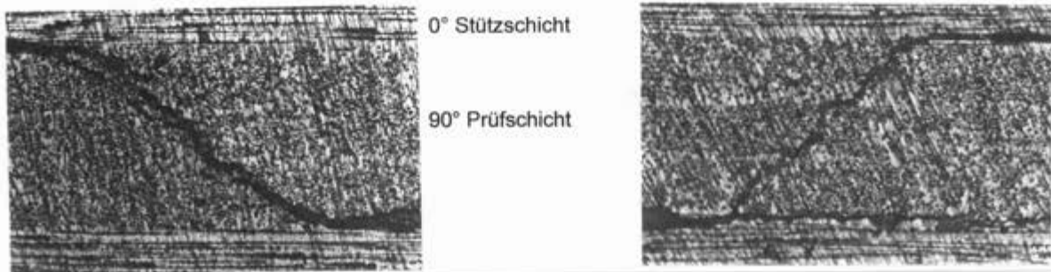
Bild 10/9: Rißbildung für (\sigma_2=0, \tau_{23}) beim in situ laminierten Verbundbiegebalken
