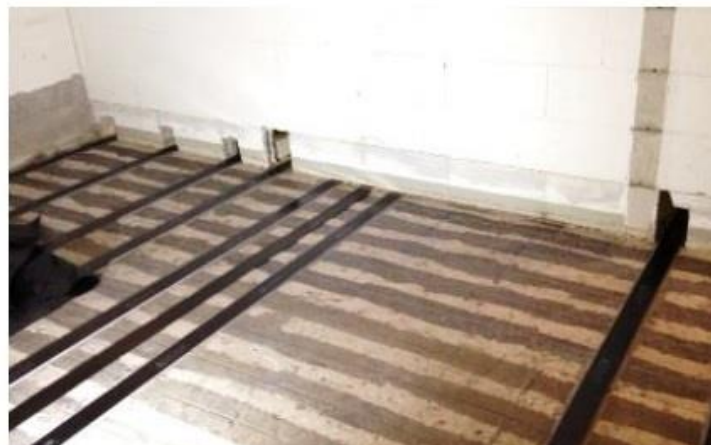
Fig.46: Nach-Vorspannungskonzept / Post-tensioning concept. Versuchsbalken zur Vorspannung mit CFK-Lamellen 20 mm x 3 mm in Schlitten. Test beam for pre-tensioning with CFRP-lamellas 20 mm x 3 mm in slits. [HPTL- FiS = Force in Slit, mit Fa. Züblin und Fa. Paul Vorspanntechnik, TU Wien, NSM-PT System]
