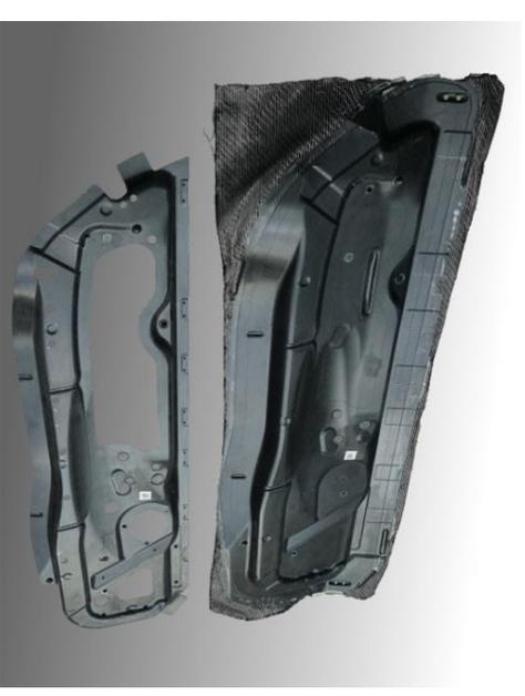
RTM-Bauteil nach Pressvorgang (oben) und nach spanender Bearbeitung (unten)
