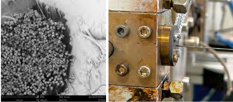
Abb. 1: CF-Endlosfaser-verstärktes Filament der ersten Generation (li.) und Versuchsreihe mit optimierter Imprägnier-Düse (re.)
