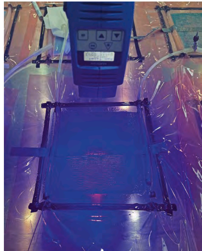
Glasfaser-UV-Aushärtung im VARI-Verfahren
