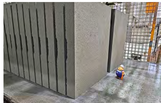
Betonplatte aus C30/37 mit nichtmetallischer Bewehrung
