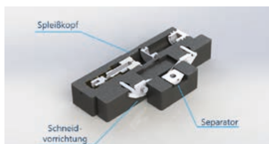
Abb. 2: Schnitt des nachrüstbaren Spleißmoduls als CAD-Modell
