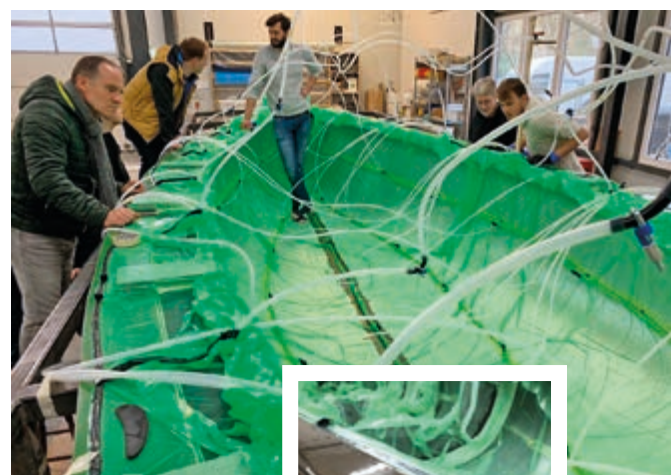
Klassische Herstellung eines Bootsrumpfes im Vakuum-infusionsverfahren
