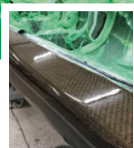
Klassische Herstellung eines Bootsrumpfes im Vakuum-infusionsverfahren
