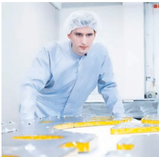
Visuelle Inspektion der Sandwich-Paneele
