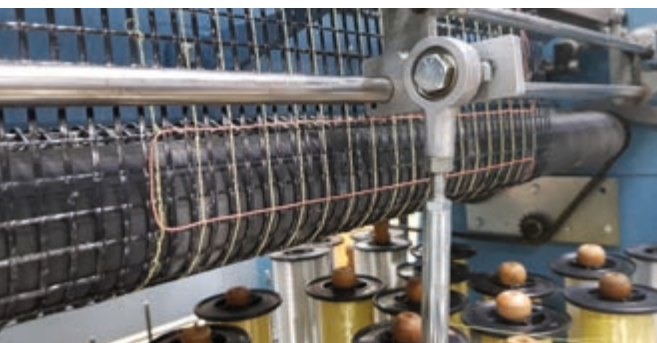
Applikation der Sensoren mit Häkelgalontechnik
