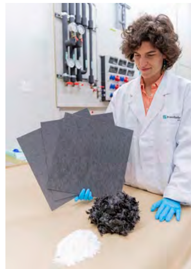
Hybridvliese aus recycelten Carbonfasern und thermoplastischen Matrixfasern
