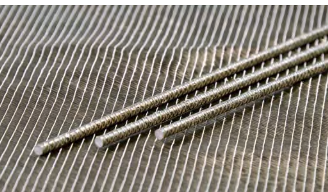
Die profilierten Stäbe werden in einem Schritt hergestellt
