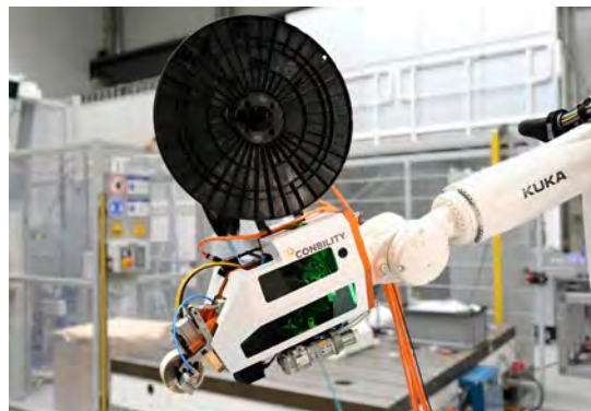
3D-Tapelegekopf: ein Werkzeug für drei Technologien
