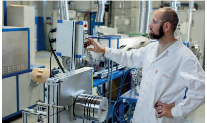
Abb.2: Stabilisierung und Carbonisierung von Zellulosefasern mittels Rohröfen
