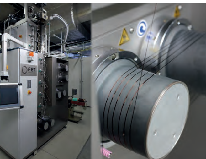
Abb.1: In der Schmelzspinnanlage werden Ligninfasern im Spinnprozess mit beheizten Galetten verstreckt.
