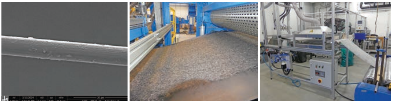
Abb. 2: Wiederbeschichtete Carbonfasern (li.), deren Verarbeitung zu Vliesstoffen (Mitte) und Teststand zur Wiederbeschichtung von Vliesstoffen (re.)
