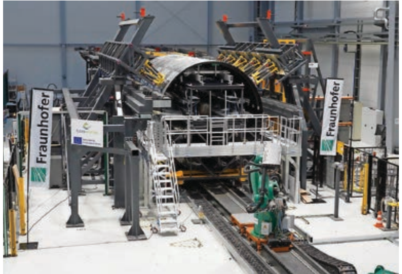
Die MFFD-Montage-Forschungsplattform mit integrierten thermoplastischen Rumpfschalen bei Fraunhofer in Stade
