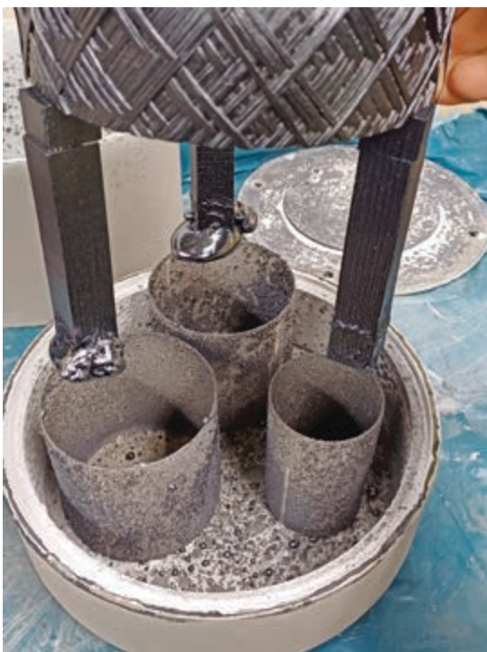
Abb. 1: Beispielhafte Anwendung der pBN-Tiegel zur Silizierung mithilfe von Dochten
