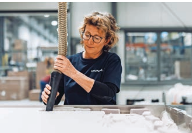
Mit dem 3D-Sanddrucker der neuesten Generation entstehen Formen und Kerne für den Metallguss
