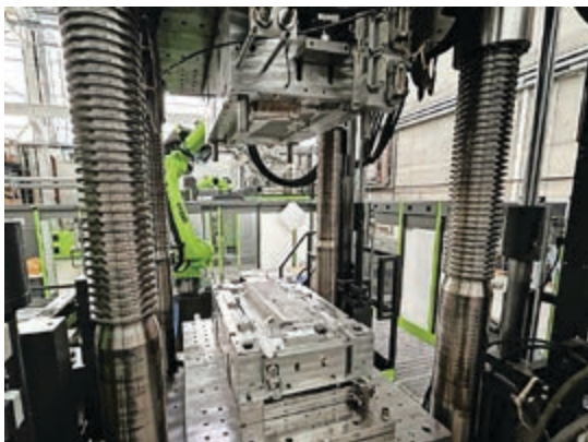
Werkzeug für Thermoplast-Sandwich-Staufachklappe in Spritzgießmaschine ENGEL v duo700 am Fraunhofer IMWS
