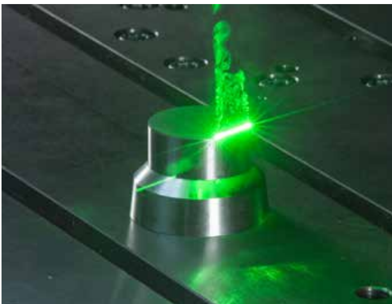
Abb. 1: Laserbasierte Oberflächenbehandlung von Stahl
