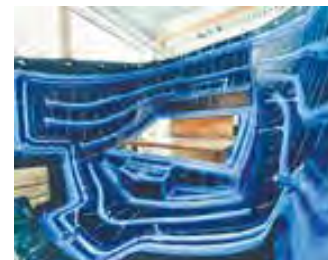
Funktionsintegrierte Vakuumhaube mit fluiddynamisch optimierten Fließkanälen
