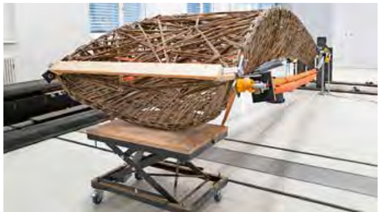
Computerbasierter Entwurf, robotische Fertigung, neues Materialsystem – nach der Prototypen-Vorserie im ICD/ITKE fertigte der Industriepartner des Projekts, die FibR GmbH Stuttgart, die 15 Faserelemente des Pavillons
