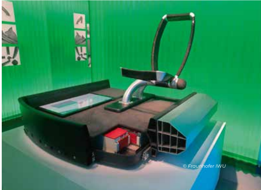
Abb. 1 Demonstrator der wiederverwendbaren E-Fahrzeugplattform und Sitzstruktur auf der Mailänder design week
