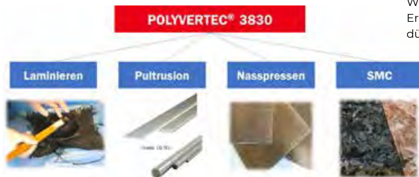
Abb. 2: Verarbeitungsverfahren für Polyvertec® 3830
