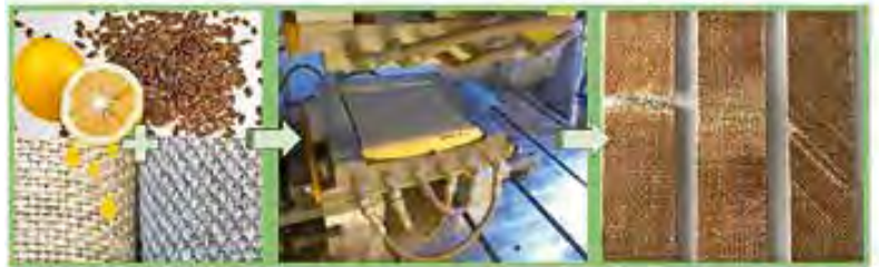
Composites mit 100 Prozent biobasiertem Kohlenstoffanteil – biobasierte Harzrezeptur im Resin Transfer Molding Prozess
