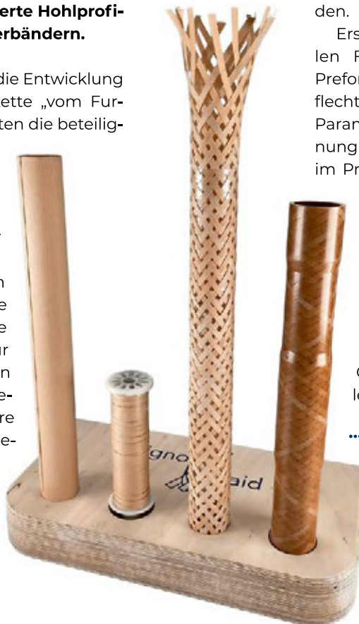
Demorohre – kleine Auswahl möglicher Hohlprofile aus biobasierten Holzverbunden
