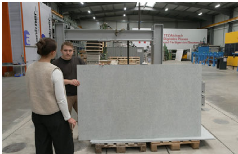
Diese Gipsfaserplatte besteht aus Alttextilfasern
