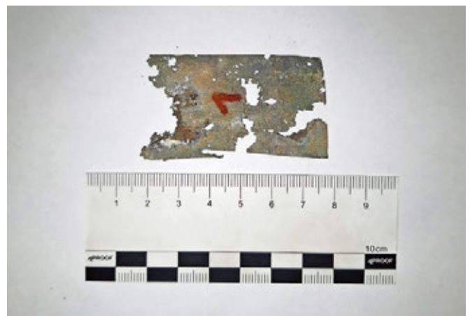
Entnommene Blechprobe mit flächiger Korrosion und vollständigem Querschnittsverlust durch Lochfraß. Maßstab 10 cm
