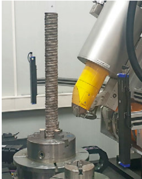
Brückenspannglied im Computertomographen (CT)
