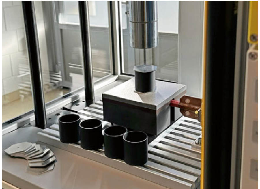
Industrielle Fügezelle für das thermische Direktfügen von Metall und Kunststoff
