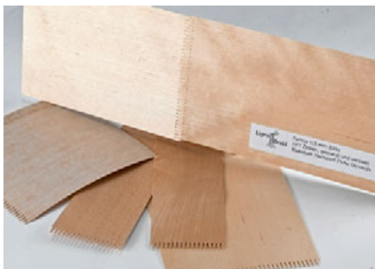
Aus speziell verzinkten Birke- und Buche-Holz furnierplatten (oben) entstehen beim Slitting (rechts) kontinuierliche Furnierbänder zur Weiterverarbeitung
