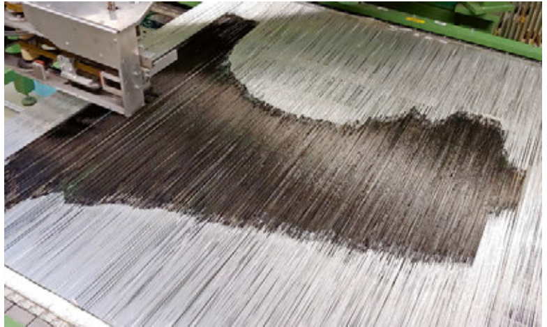
Abb. 3: Textiles Halbzeug eines PKW-Kotflügels aus Carbonfasern auf einer Multiaxial-Kettenwirkmaschine (Malimo 14024)
