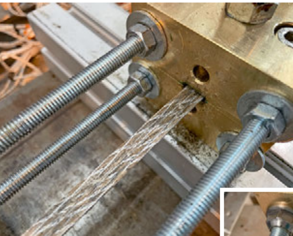
Herstellen eines hanffaserverstärkten (li.) und eines glasfaserverstärkten Profils (u.) mit identischen geometrischen Abmessungen mittels extrusionsbasierter thermoplastischer Pultrusion
