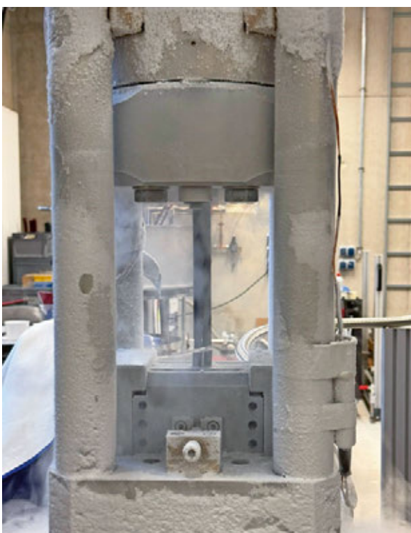
Werkstoff-Prüfung bei kryogenen Temperaturen
