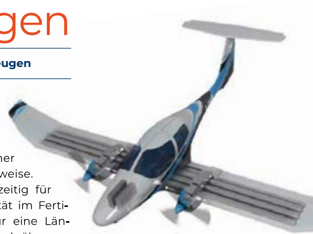
Skizze Kleinflugzeug APUS i-2 mit vier integralen Wasserstofftanks über die gesamte Flügelspannweite
