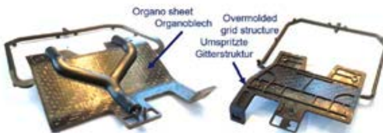
Abb. 2: Demonstratorbauteil, umspritzt mit Mischung aus 80% Neuware und 20% gemahlenem Organoblech
