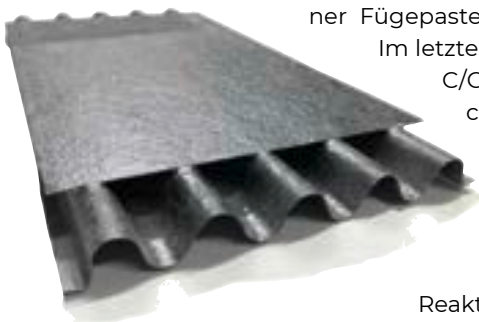
Abb. 3: SiSiC Sandwichdemonstrator (ca. 280 x 140 x 20 mm 3 , t ca. 1 mm) in endkonturnaher Sandwichbauweise; hergestellt über das LSI-Verfahren und prozessintegrierter Fügetechnik
