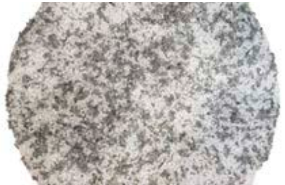
Abb. 1: Dem Neugranulat wird das gemahlene Organoblech (grau) beigemischt
