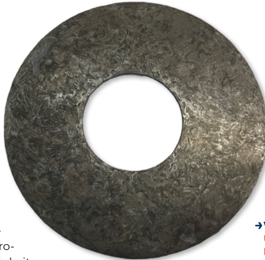
Abb. 2: C/C-SiC-Demonstrator, basierend auf C/PEEK-Hybridgarn ( \varnothing a = 130 \text{ mm} \varnothing i = 50 \text{ mm} , Dicke = 2 mm)
