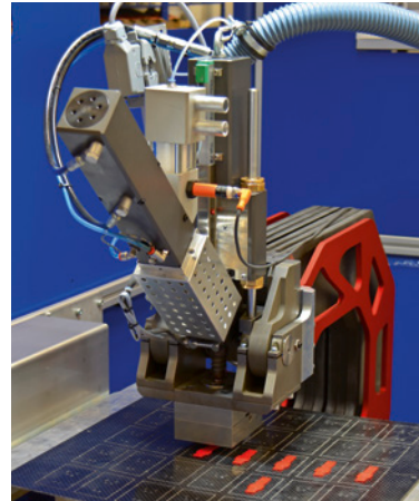
Abb. 2: ROBIN im ersten Anwendungsbeispiel zur lokalen Spritzgieß-Funktionalisierung von Organo-blechen
