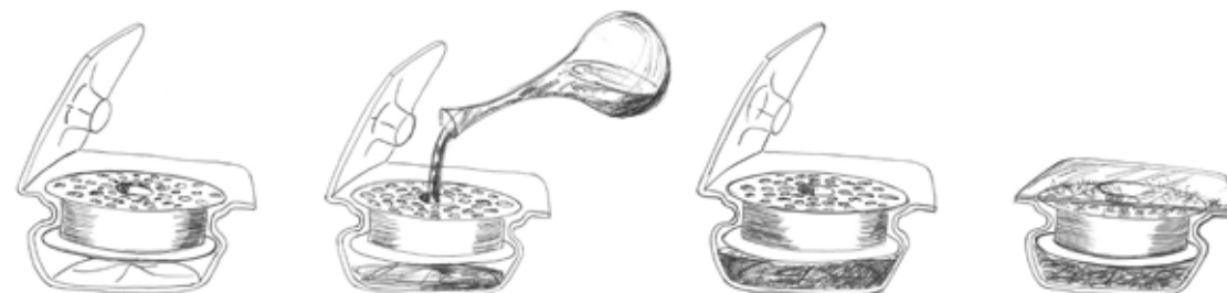
Schematischer Infiltrationsablauf: 1) Infiltrationsbehälter mit eingelegter Spule 2) Befüllen des Harzreservoirs durch die Spulenachse 3) Vollständig befüllter Behälter, bereit für Evakuierung und Versiegelung 4) Infiltrationsvorgang im geschlossenen System quer zur Spule
