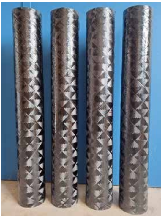
Abb. 4: Rohre mit abschließender \pm 45^\circ -Wicklung
