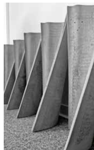
Rotorblätter aus Carbonbeton mit 10–20 mm Dicke für das Stadtraumobjekt Wind Mill © informbeton
