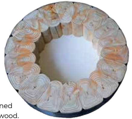
Abb. 3: Querschnitt durch ein CFK-armiertes Rohr aus verpressten Rundhölzern
