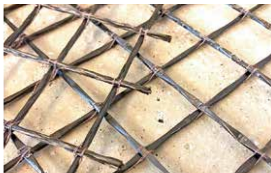
Textilbetonbewehrung aus Flecht- (l.) und Profilgarnen (r.)
