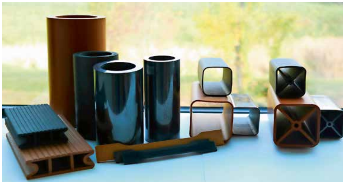
Verschiedene Geometrien hergestellter SiC-Keramiken und die zugehörigen Grünkörper und Carbon-Formkörper
