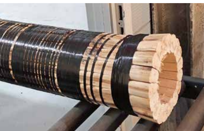
Abb. 2: Rückstellkräfte führen zur Aufweitung am Pressformausgang
