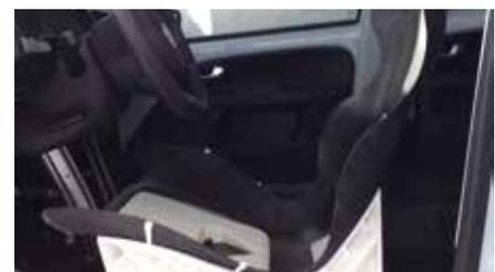
Abb. 2: Einschalige Sitzstruktur für das „50. Percentil Frau“, eingebaut im VW Up
