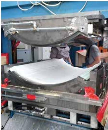
Abb. 1: Eingelegte Preform (Lagenaufbau) im neuartigen Werkzeug
