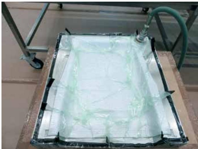
*Verformung eines ThermHex-Wabenkerns mittels Vakuumsackverfahren*
