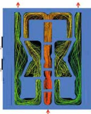
Abb. 3: Strömungssimulation der großflächigen Temperierung im Unterwerkzeug
