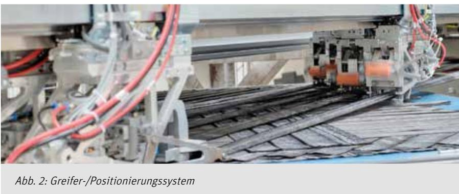
Das Ablegen der CF-Bänder in definierter Länge auf einem Trägersystem erfolgt über ein spezielles Greifer-/Positionierungssystem mit integrierter Schneidkinematik (Abb. 2). Ein rotierender Tisch (360°) unter dem Greifersystem erlaubt es, beliebige Lagenorientierungen oder lokale Verstärkungsbänder zu realisieren.
