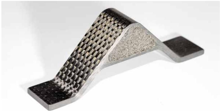
*Aha-Effekt: durch leichten Kern besonders leichtes thermoplastisch gepresstes Beispielbauteil*
