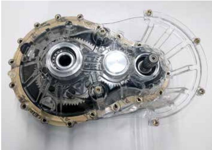
Demonstrator-Prototyp mit CFK-Getriebegehäuseschale
