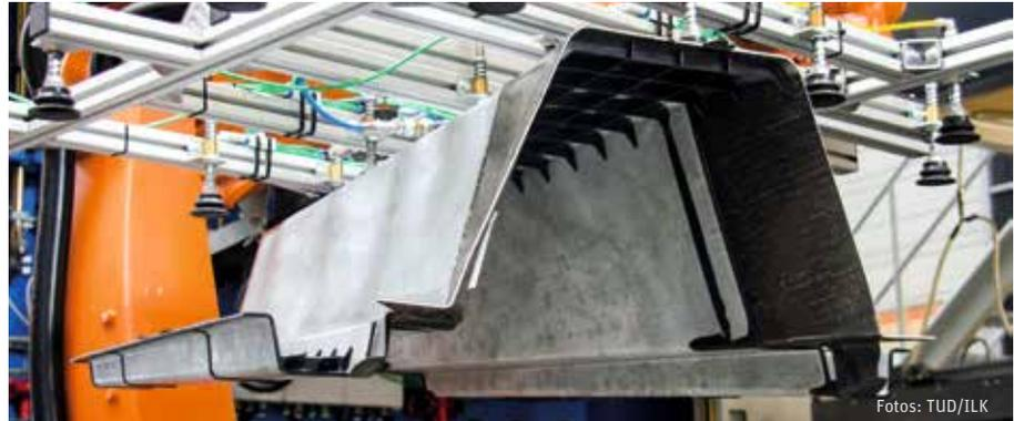
*Die Bodengruppe aus dem Projekt LEIKA kombiniert Stahl, FVK, Magnesium und faserverstärkte Spritzgussteile.*
