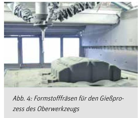
Abb. 4: Formstofffräsen für den Gießprozess des Oberwerkzeugs
