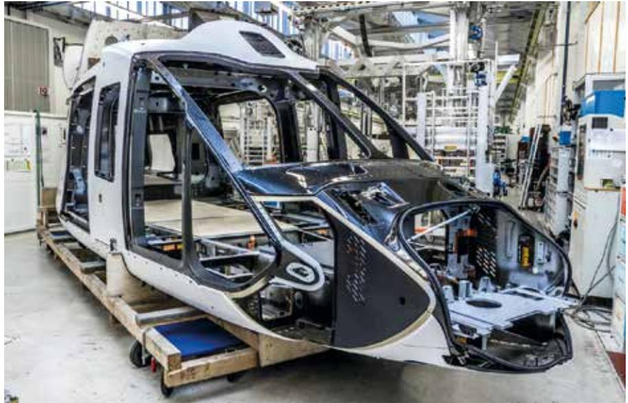
*Dank kontinuierlicher Verbesserung der CFK-Fertigungsverfahren besteht die Zelle der H160 etwa zu drei Viertel aus Carbon.*
