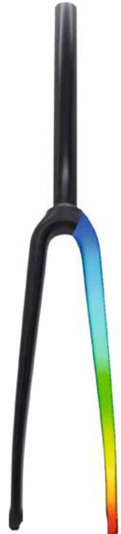
*Ergebnisse der Finite-Elemente-Modellierung und Prototyp einer Fahrradgabel*
