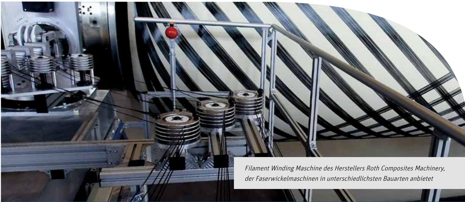
Filament Winding Maschine des Herstellers Roth Composites Machinery, der Faserwickelmaschinen in unterschiedlichsten Bauarten anbietet
