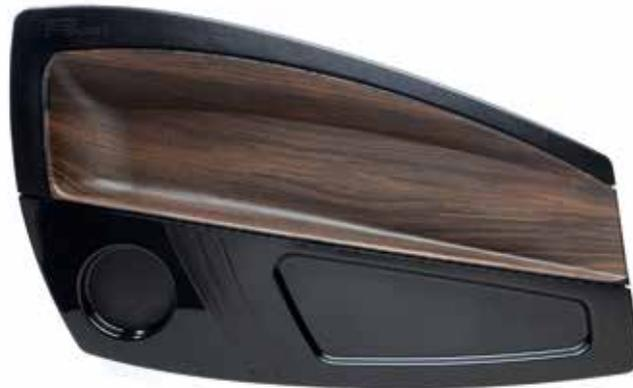
*Türverkleidung, hergestellt aus dem SAN-basierten Faserverbundwerkstoff StyLight*
