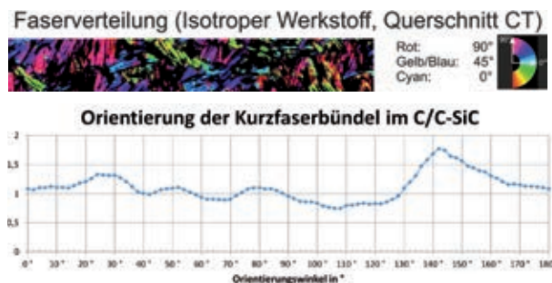
Abb. 1: Bestimmung der Faserverteilung im Volumen einer Biegeprobe (90 mm x 9 mm x 6 mm). Oben: CT-Querschnitt einer Probe mit farbkodierter Faserorientierung; Unten: Histogramm mit der quantitativen Bestimmung der Faserbündelorientierung im gesamten Probenvolumen
