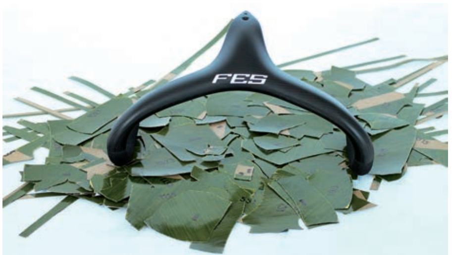
Das Ergebnis einer numerischen Bauteiloptimierung, der Sprintlenker SL11 – ein Puzzle aus 136 Einzelteilen
