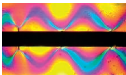
Glasfaserherstellung (I.), AFM-Aufnahme einer geschichteten Glasfaseroberfläche (M.o.), single fibre fragmentation test (M.u.), Beispiel für maßgefertigte Verbundgestaltung mittels Tailored Fiber Placement (r.)
