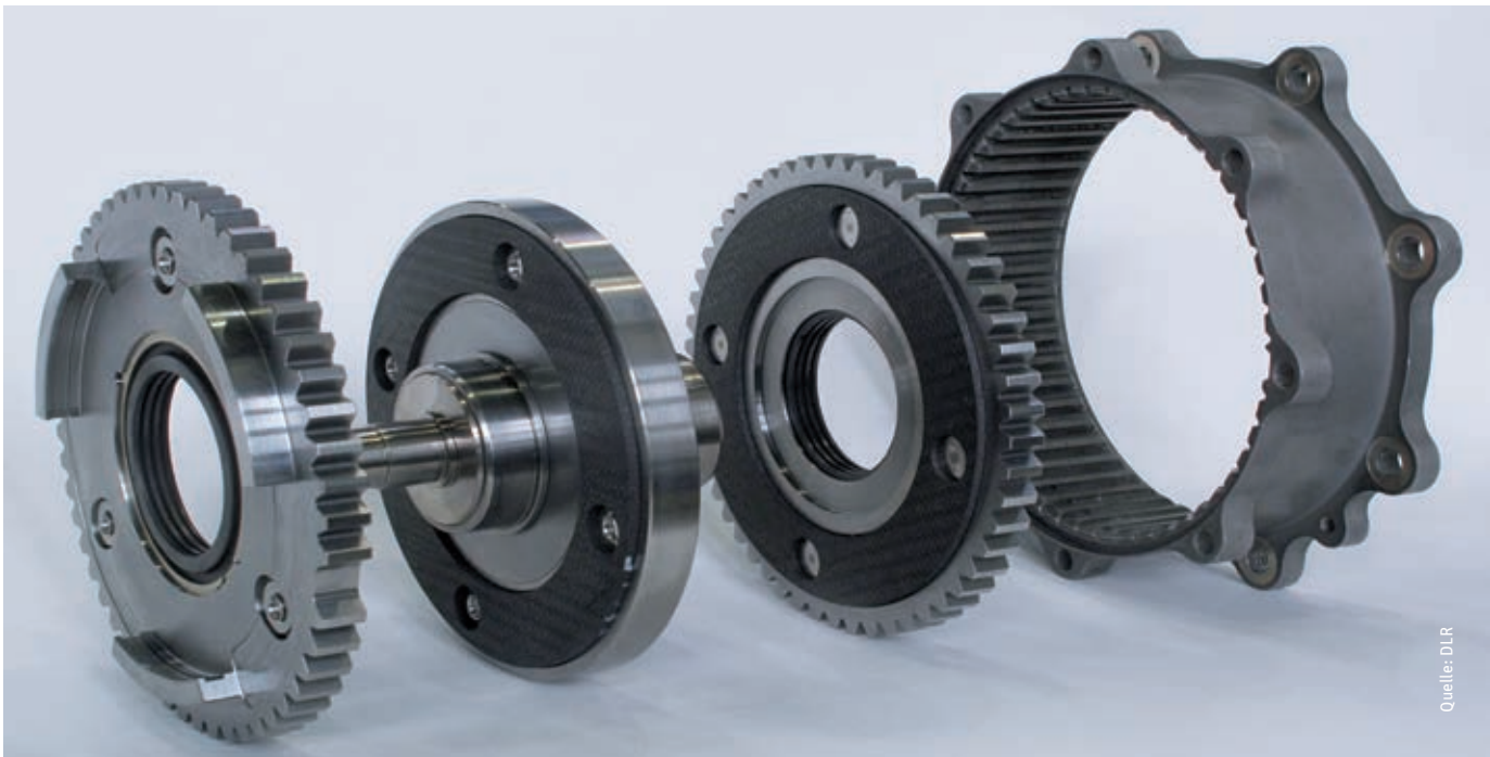
Propellerbremse, bestehend aus drei Bremsringen (ein Rotor, zwei Statoren) mit C/C-SiC Reibbelägen und dem Gehäuse
