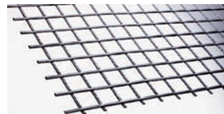
Ein textiles Gelege aus epoxidharzgetränkten Carbonfasern der solidian GmbH, wie es in Textilbeton zum Einsatz kommt
