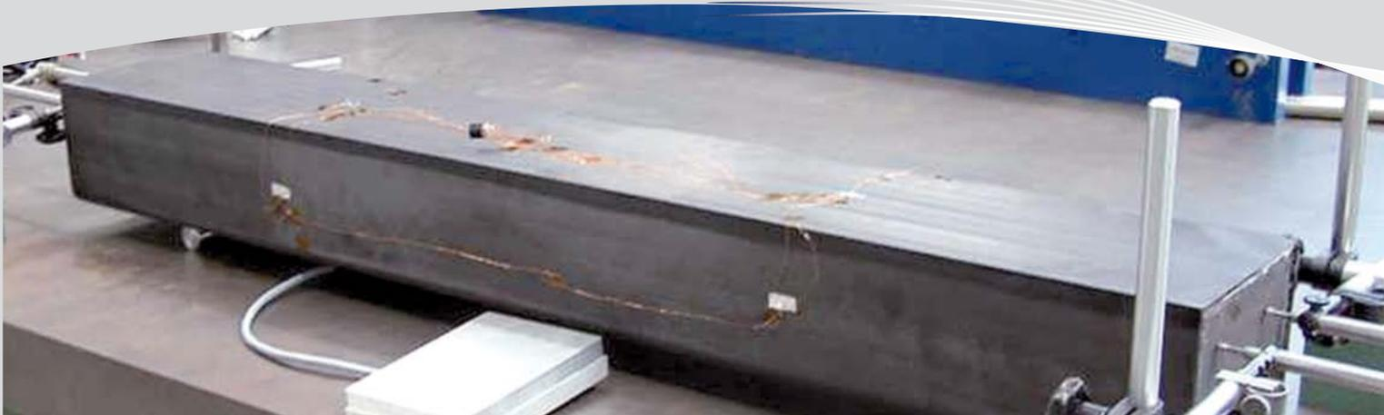
Bild 1: Formstabiler CFK-Manipulatorarm (Vermessung)
