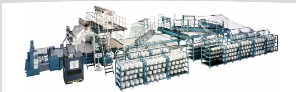
*Multiaxial-Nähwirkmaschine und Webmaschine mit Jacquardeinrichtung*
