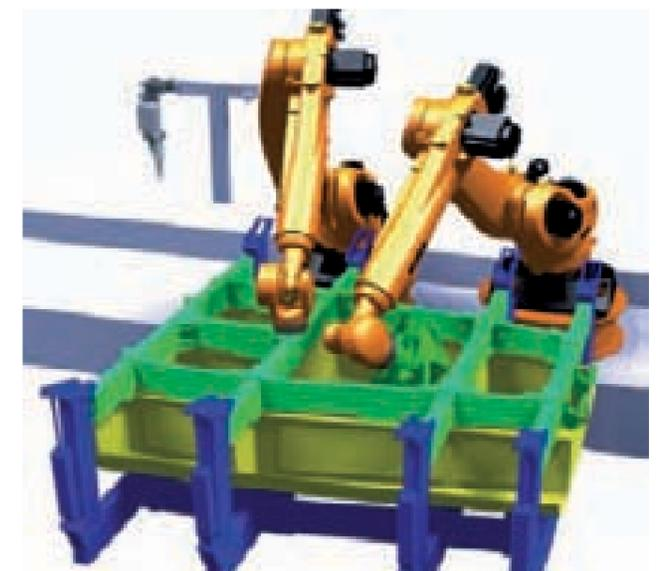
Abb. 4: Automatisiertes Fügen der Schale mit dem Framework (Quelle: DLR ZLP)
