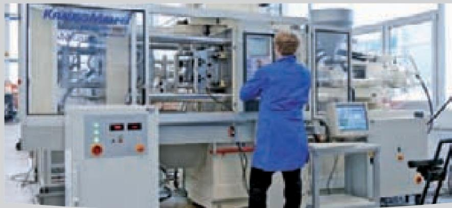
Pilotanlage im Technikum der Neue Materialien Fürth GmbH: Spritzgießmaschine mit geöffnetem Werkzeug und eingefahrenem Handlingsystem, Spannungsversorgung für die Aufheizung der C-Fasern (links) sowie Messwerterfassung mit PC und Ansteuerung des Handlingsystems (rechts).
