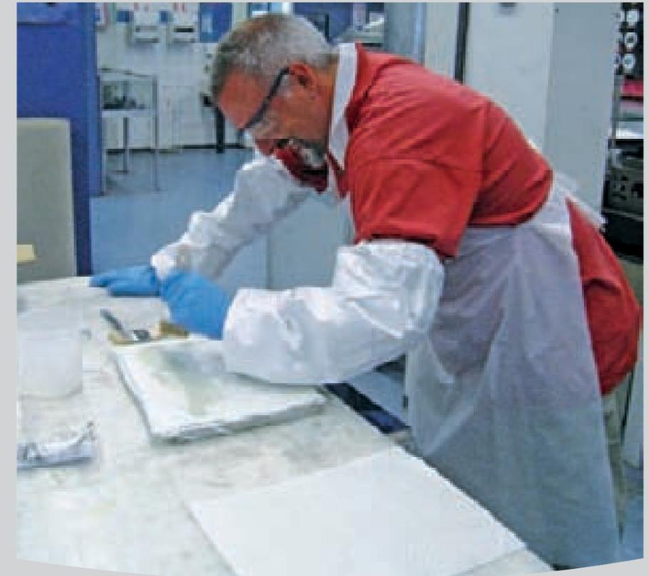
Erste Nasslaminatversuche anhand einer einfachen GFK-Platte
