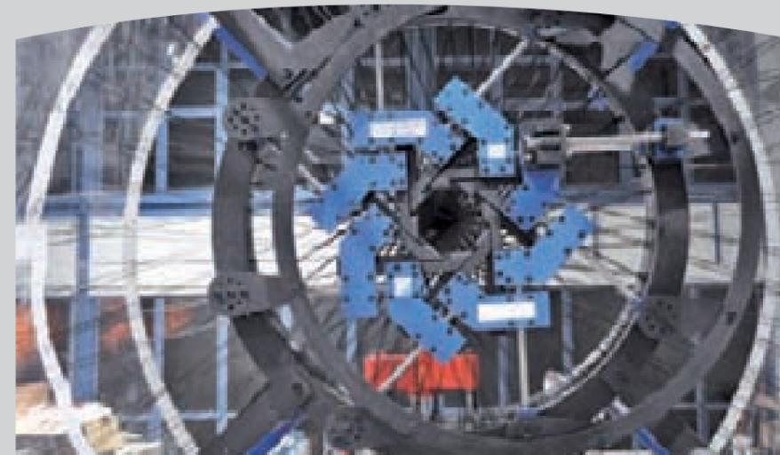
Variables Flechtauge („Iris“) zur Herstellung von Bauteilen mit großen Durchmessersprüngen
