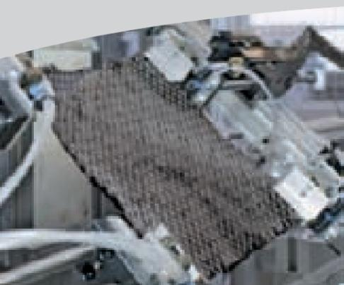
Handlung eines trockenen, biegeschlaffen Kohlenstofffasergeleges im geöffneten Werkzeug einer Spritzgießmaschine
