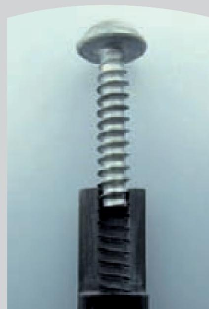
Direktverschraubung in CFK-Material mit willkürlicher Faserausrichtung
