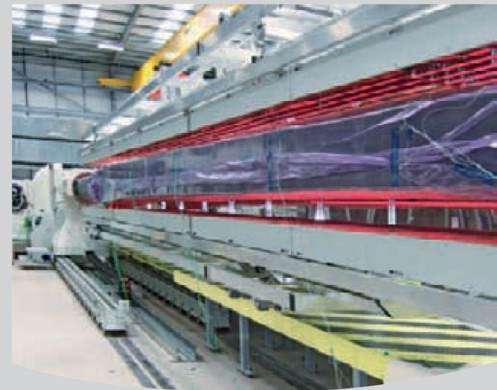
Infrarot-Wärme hilft, Strukturstörungen bei Flugzeugteilen zu verhindern.
