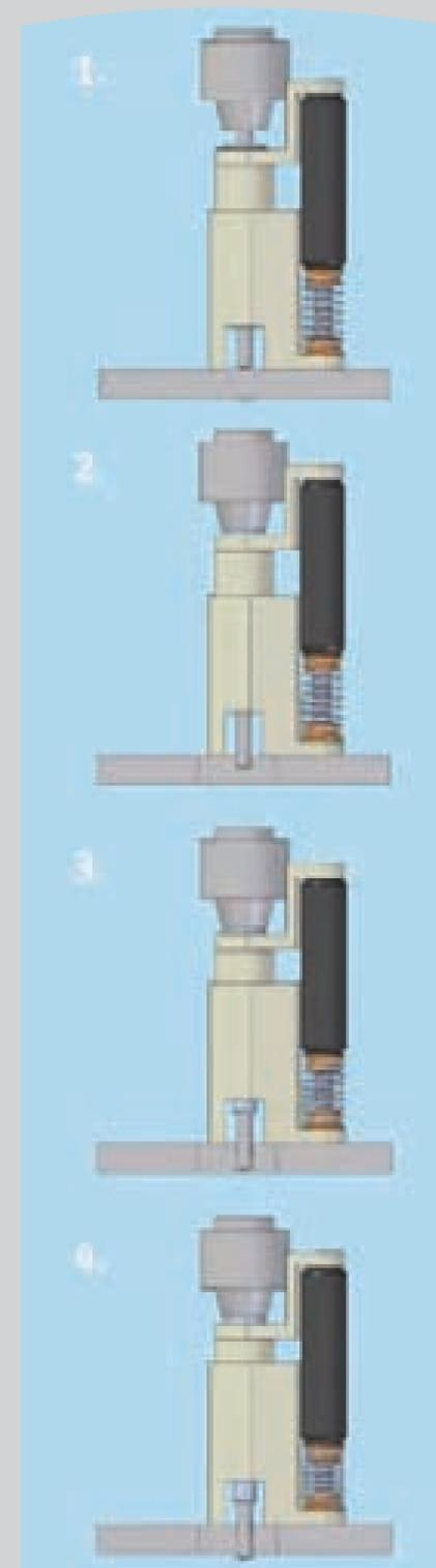
Ablaufschema des Bohrens in Composite-Werkstoffen mit Handbohrmaschine und patentierter adaptiver Gühring Vorschubdämpfung
