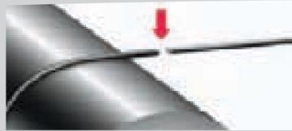
Filament-Bruch bei Faser führenden Teilen
