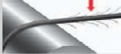
Spliss-Erscheinungen (Ablösung von Einzelfasern) bei Roving-Verarbeitung
