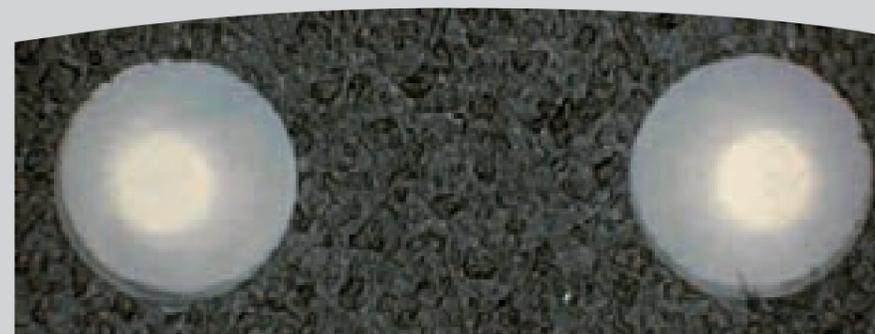
Sauberer Bohrungsaustritt: Mit Gühring Bohrer-geometrie und patentierter adaptiver Vorschubdämpfung können unidirektionale Composites problemlos bearbeitet werden.
