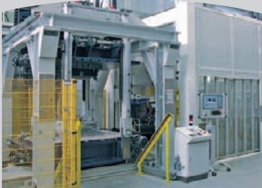
PUR-Verarbeitungszentrum des ILK mit Sprühvorrichtung und Shuttle-Formenträger
