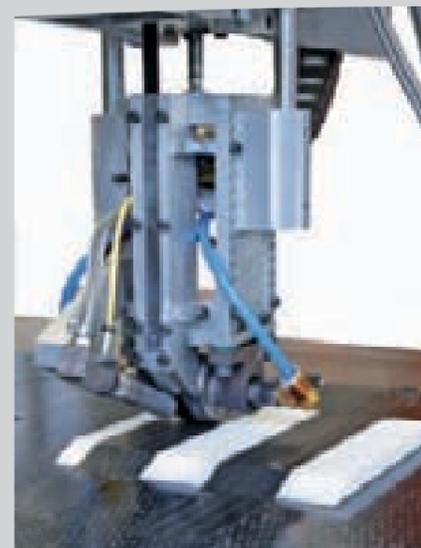
Thermoplast-Tapelegekopf mit Hybridbauteil (Sandwichstruktur)
