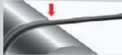
Verstärkungsfasern, wie etwa Carbon-/Glasfaser-Composites zeigen ein besonders aggressives Abrasionsverhalten
