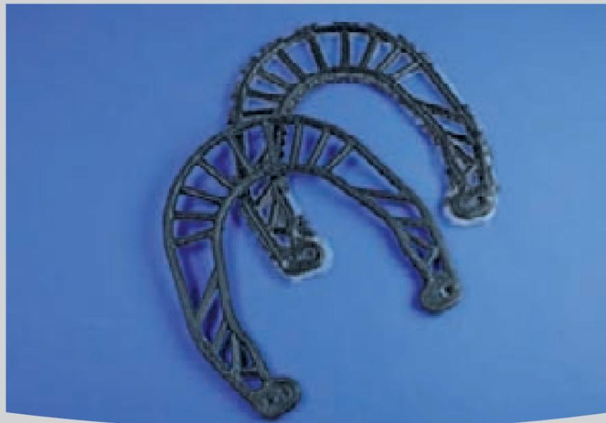
Strukturoptimierter Leichtbau in Form eines Brakeboosters © Bauteilauslegung und -herstellung: Leibniz-Institut für Polymerforschung IPF Dresden e.V.; Endbearbeitung mittels Remote- Laserschneiden: Fraunhofer IWS Dresden“
