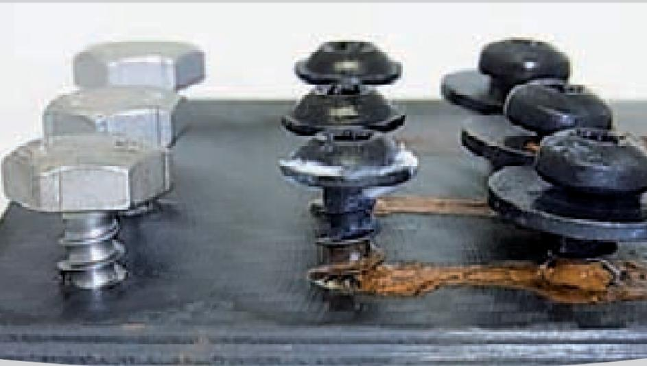
Korrosionsangriff an Schrauben mit einer Zink-Nickel-Oberfläche nach 48h Salzsprühnebeltest
