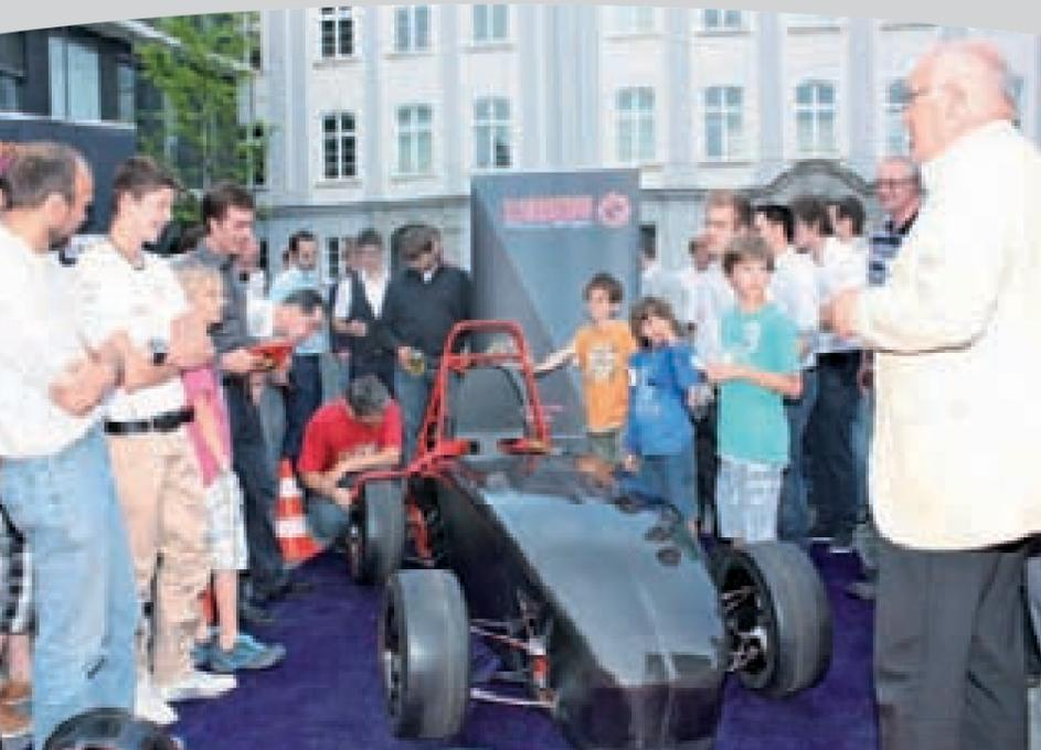
Asrael: Der Rennwagen mit elektrischem Antriebssystem zählt 92 PS, hat ein Drehmoment von 535 Nm pro angetriebenem Rad und erreicht mit seinem Heckantrieb eine Höchstgeschwindigkeit von rund 160 km/h.
