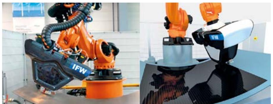
*HP CFK-Legkopf des Instituts für Fertigungstechnik und Werkzeugmaschinen (IFW), Hannover, und in CAESA TapeStation integriertes Robotermodell*
