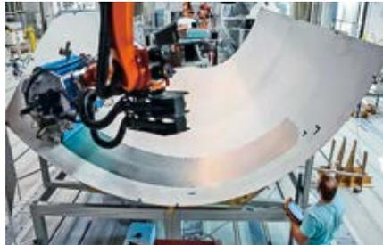
Abb. 1: Rumpfschale während der automatisierten Ablage von Blitzschutz
