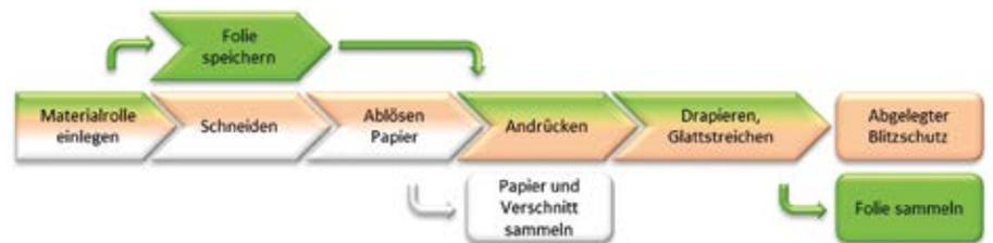
Abb. 2: Automatisierter Ablageprozess für Blitzschutz
