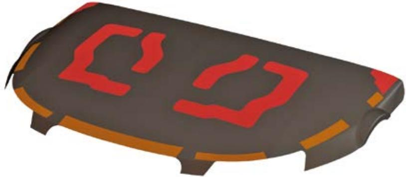
*Variotherme Klebewerkzeuge mit unterschiedlichen Heizzonen und Temperaturprofilen (beispielsweise rot T = 140 °C und orange T = 80 °C)*
