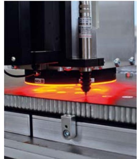
*Schneiden, Bohren, Kleben: Vollautomatisch übernimmt die Automated Potting Machine (APM) Herstellung und Dokumentation von Leichtbau-Paneelen.*
