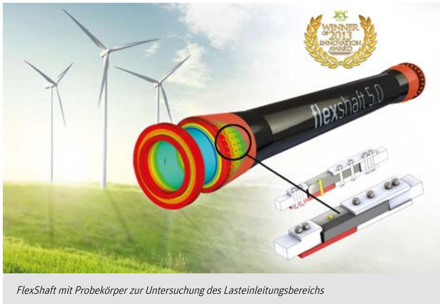
FlexShaft mit Probekörper zur Untersuchung des Lasteinleitungsbereichs
