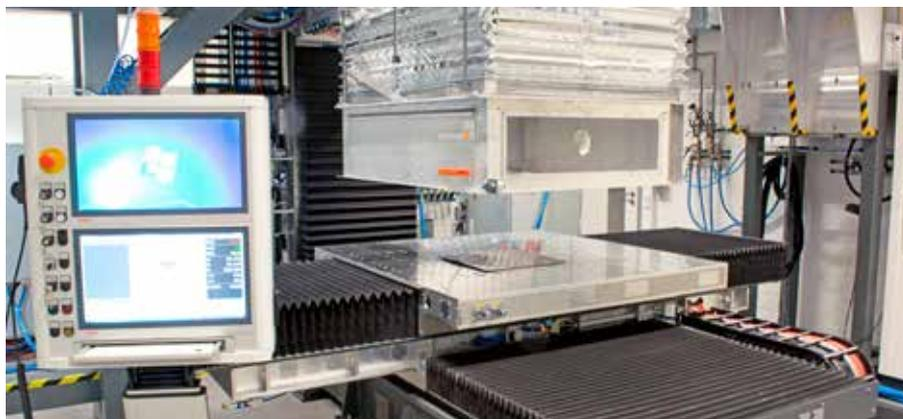
*Multi-Remote-Anlage zur Großflächenbearbeitung mit Laserstrahlung und Atmosphärendruckplasma*
