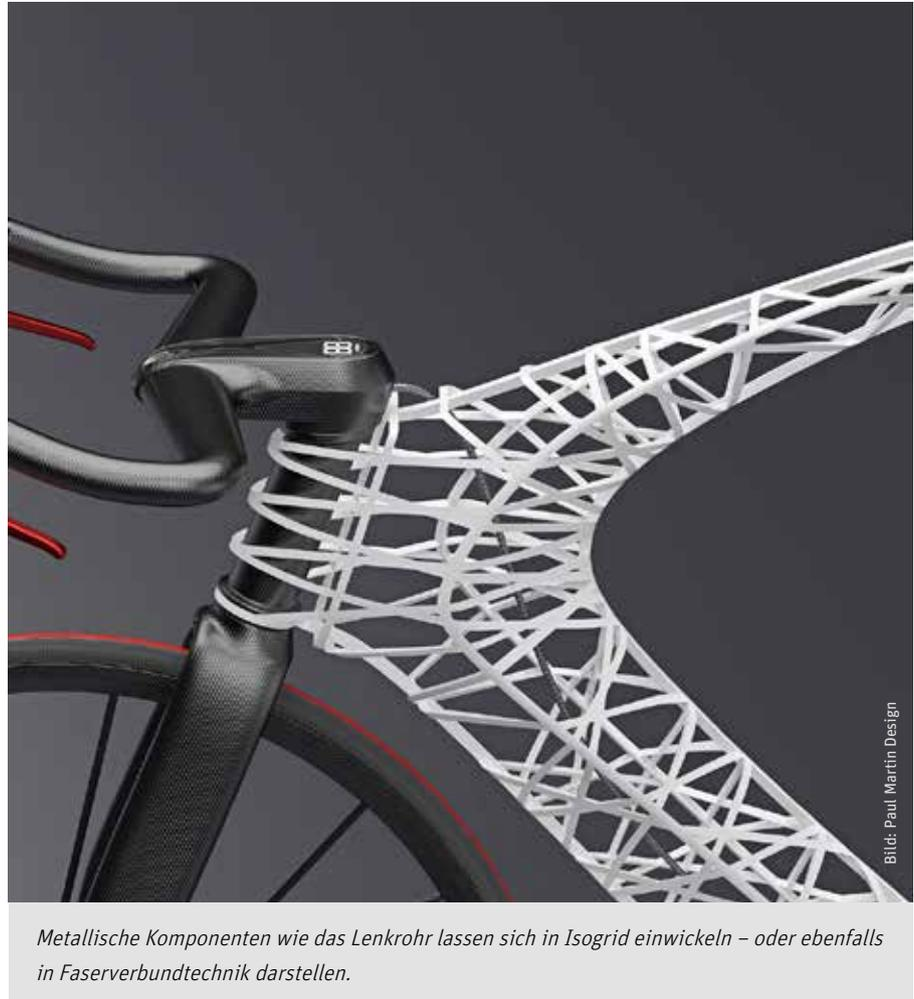
*Metallische Komponenten wie das Lenkrohr lassen sich in Isogrid einwickeln – oder ebenfalls in Faserverbundtechnik darstellen.*
