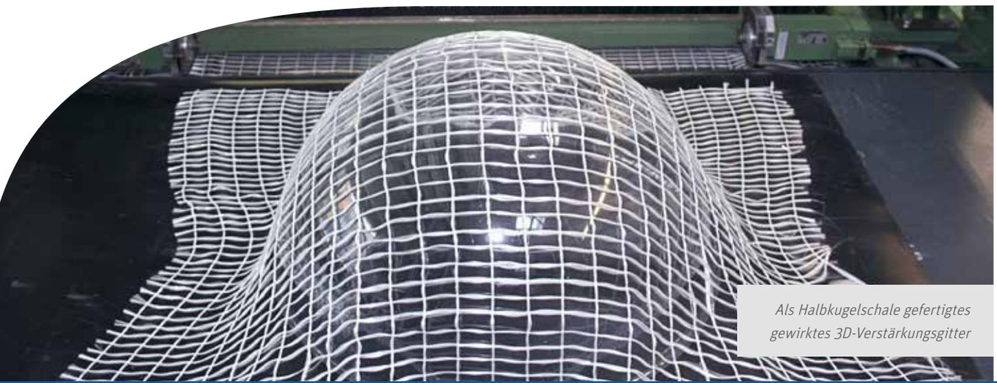
Als Halbkugelschale gefertigtes gewirktes 3D-Verstärkungsgitter
