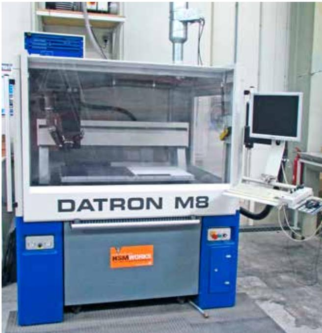
*Drei-Achs-Fräsmaschine Datron M 8, speziell optimiert für die Composite-Bearbeitung*
