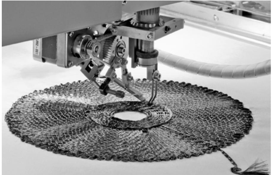
*CNC-Legekopf bei der lastpfadgerechten Ablage eines Kohlenstofffaser-Rovings*
