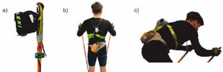
Einsatzbereites Monitoringsystem (a), Rückansicht des Sportlers mit Elektronikmodul im Trinkgurt (b) und Sportler auf dem Laufband des IAT (c)
