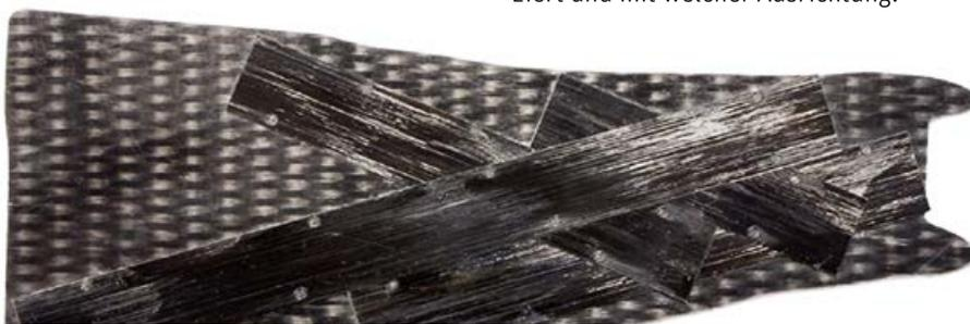
Abb. 1: Zwischenprodukt – Organoblech, mit Patches verstärkt
