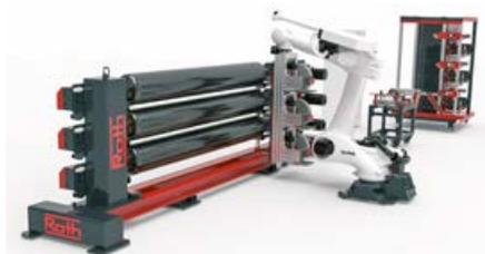
*Mit seinen Roboter Filament Winding Anlagen vervollständigt Roth Composite Machinery sein Produktprogramm*
