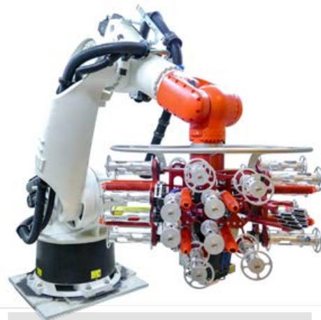
Prozessintegration über verschiedene Produktionsschritte: STAXX flex End-effektor für die 2D- und 3D-Faserablage
