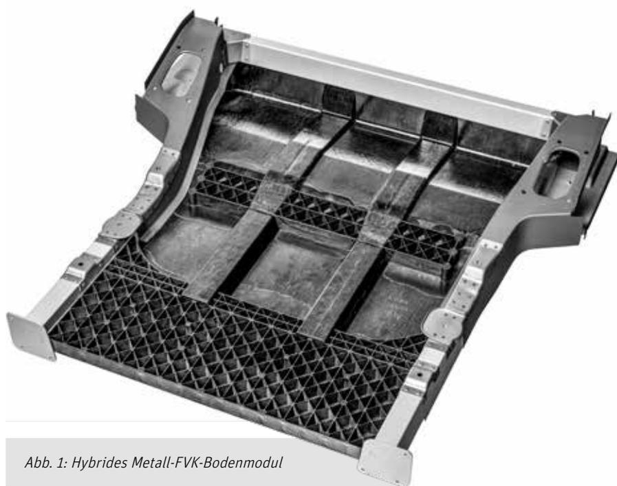
Abb. 1: Hybrides Metall-FVK-Bodenmodul
