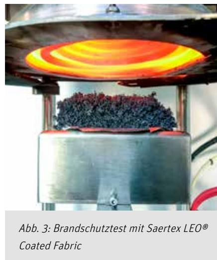
Abb. 3: Brandschutztest mit Saertex LEO® Coated Fabric
