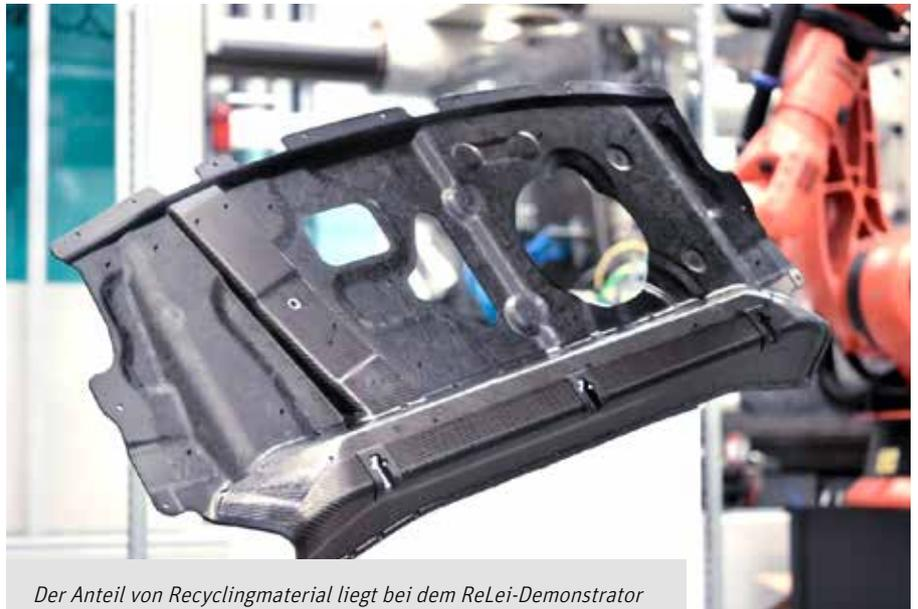
*Der Anteil von Recyclingmaterial liegt bei dem ReLei-Demonstrator insgesamt bei etwa 80 Prozent*
