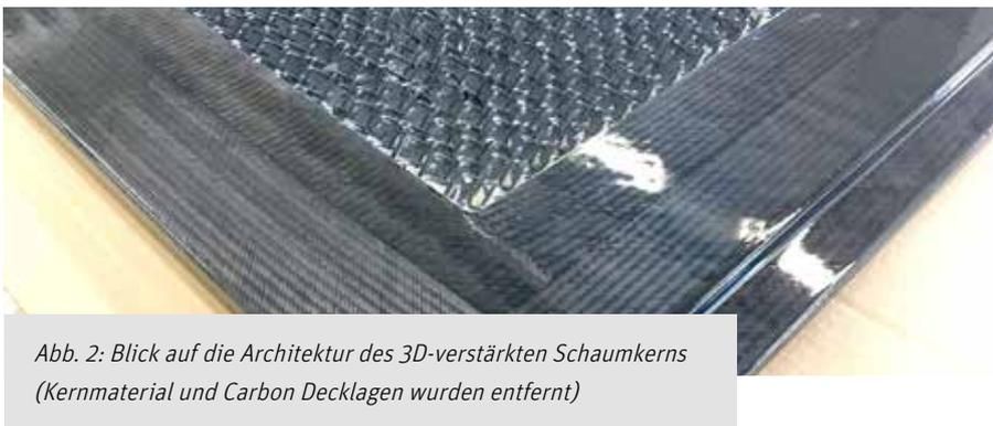
Abb. 2: Blick auf die Architektur des 3D-verstärkten Schaumkerns (Kernmaterial und Carbon Decklagen wurden entfernt)
