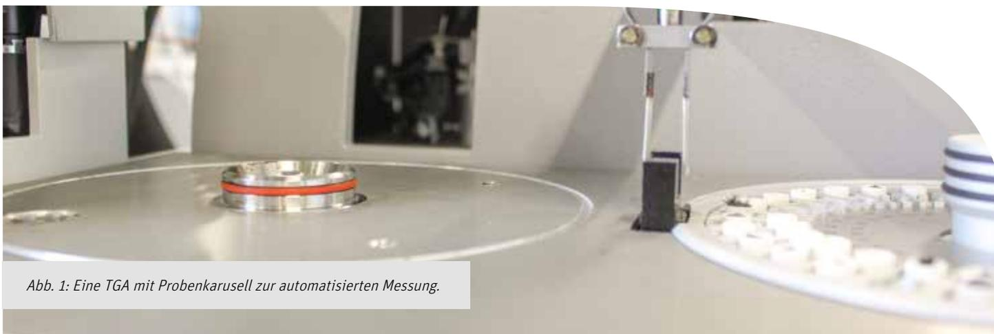
Abb. 1: Eine TGA mit Probenkarusell zur automatisierten Messung.
