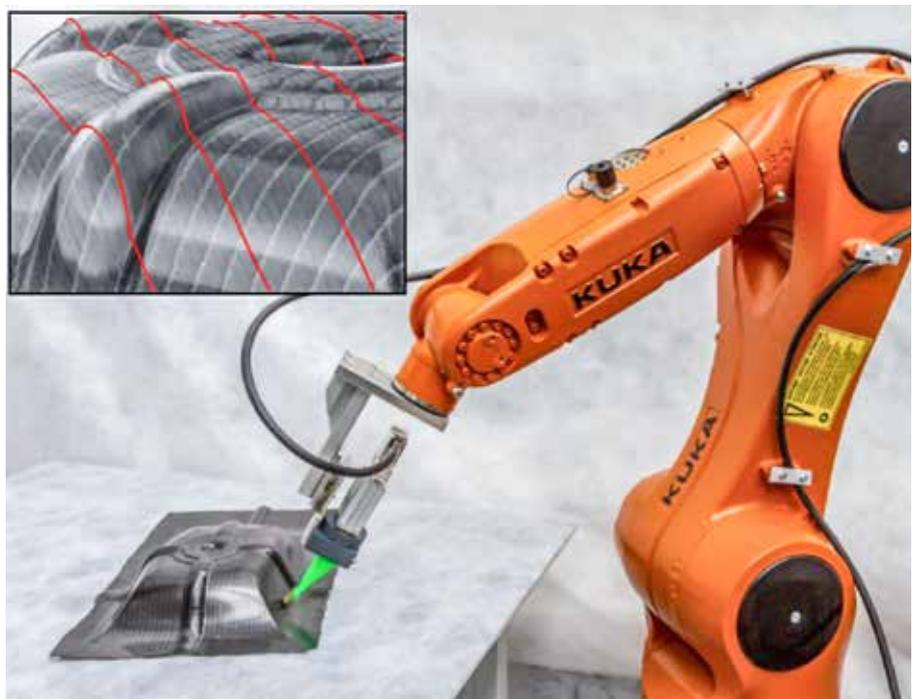
Abb. 1: Robotergeführte Wirbelstromprüfung und optische Validierung an einem CFK-Bauteil
