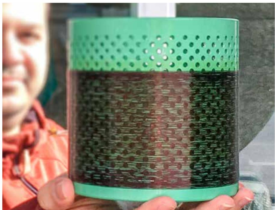
*Ergebnis der Spinnversuche in Tampere/Finland: Spule einer ligninbasierten Präkursorfaser, gesponnen mittels Dry-Jet-Wet-Spinnverfahren*
