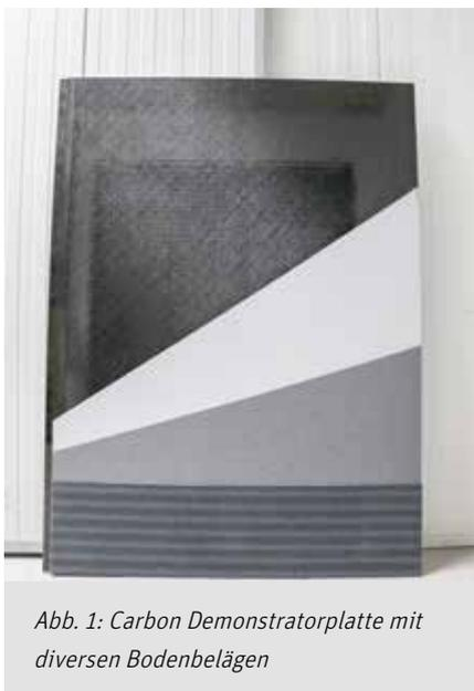
Abb. 1: Carbon Demonstratorplatte mit diversen Bodenbelägen
