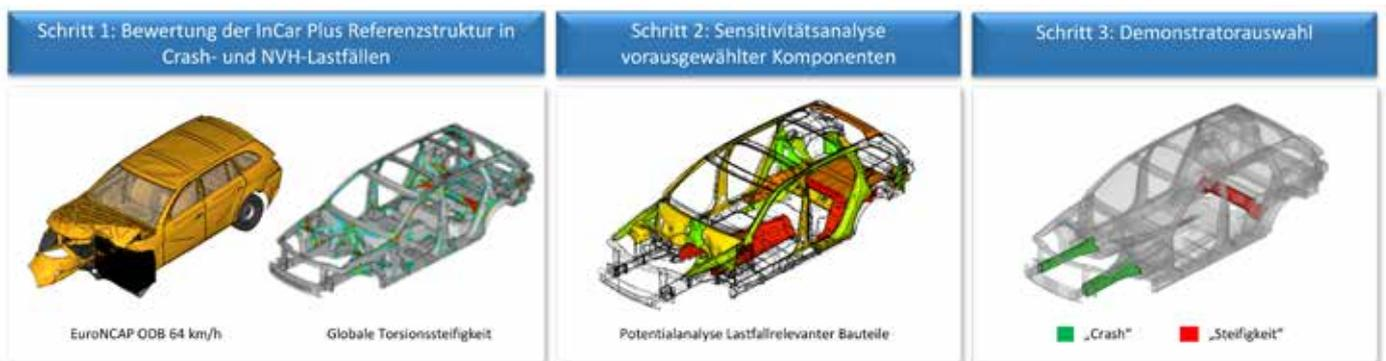
Abb. 2: Ablauf der Bauteilwahl anhand einer Simulation
