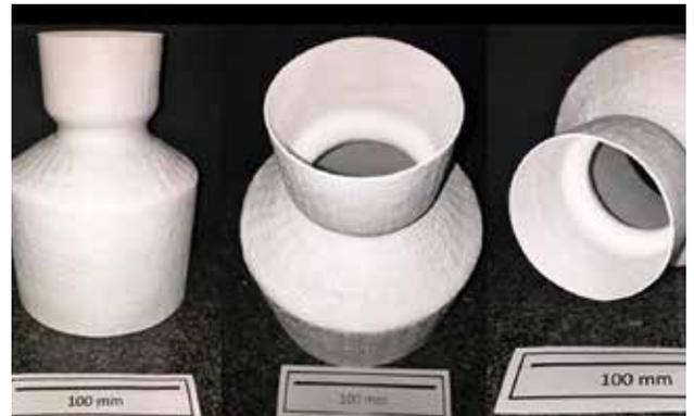
Direktinfiltration: Vakuuminfusion – komplexe 3D-Geometrie
