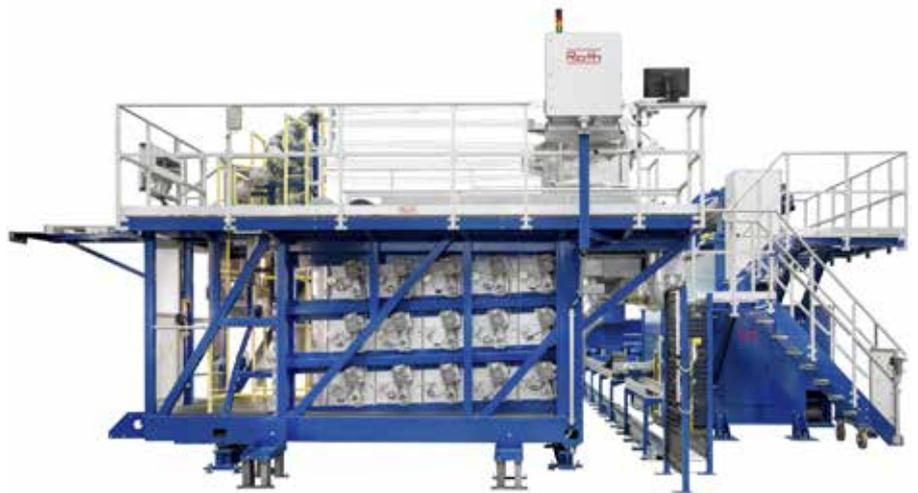
*Die Filament Winding Anlage von Roth Composite Machinery für die Herstellung von Boostern für die Ariane 6 Rakete ist eine der größten Anlagen des Herstellers überhaupt*
