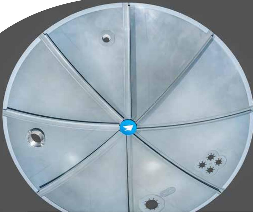
Wichtiges Bauteil – die Druckkalotte schließt den Passagierraum eines Flugzeugs gegen sein Heck luftdicht ab
