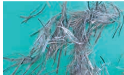
Abb. 1: Carbonfaserrezyklat nach einstufigem Reißprozess
