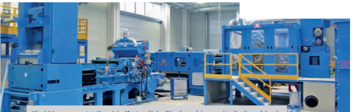
Vliesbildungsaggregate während der Montage (links: Wirtvliesverfahren; rechts: Kardiervverfahren)
