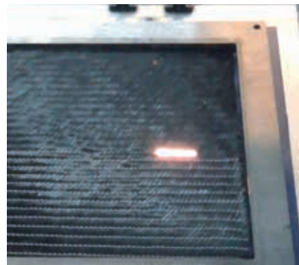
Abb. 2: Einwirkung des Laserstrahls auf die zu entfernenden Nähgarne
