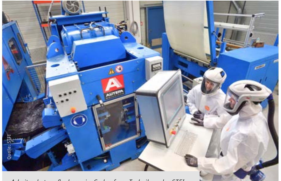
Arbeitsschutzmaßnahmen im Carbonfaser-Technikum des STFI
