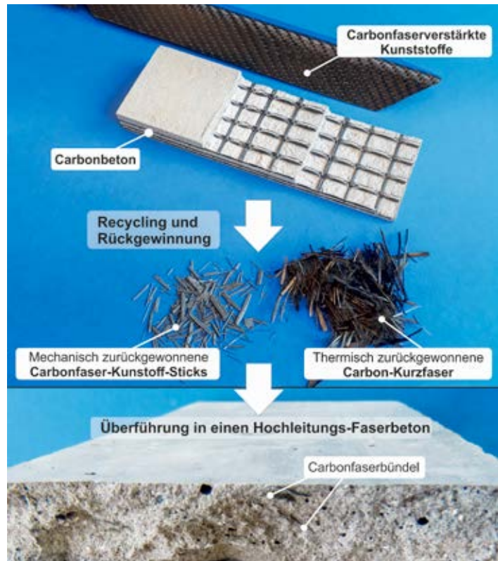
Vom End-Of-Life-Bauteil zum Hochleistungsbeton mit Bewehrung aus recycelten Carbonfasern
