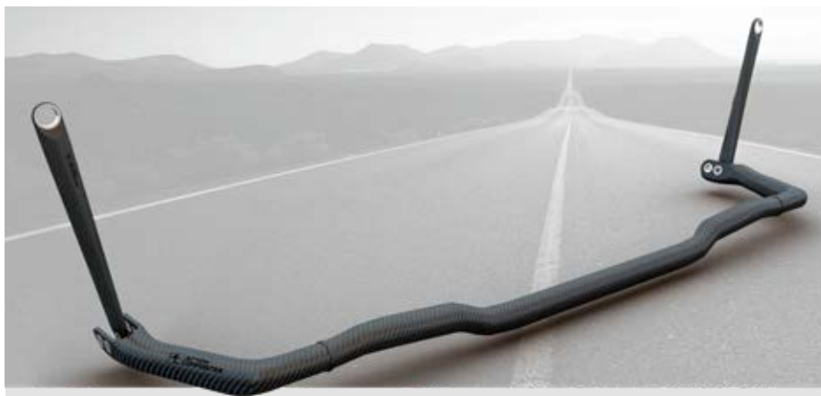
Anwendungsbeispiel Fahrwerkssystem der Porsche 911 GT3RS-Serie, ausgezeichnet mit dem JEC Asia Innovation Award 2018. Im Bild CFK-Stabilisator an der Vorderachse
