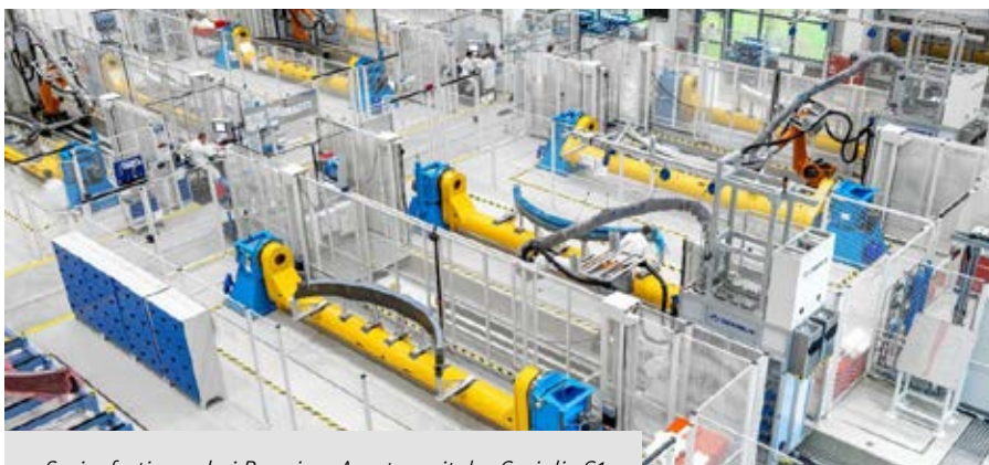
Serienfertigung bei Premium Aerotec mit der Coriolis C1
