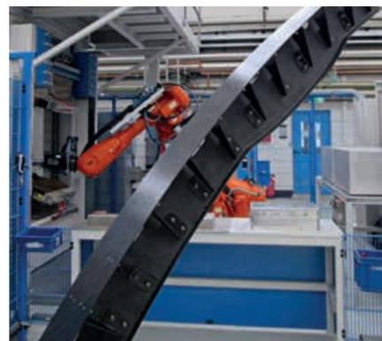
*Thermoplastspant mit integrierten Verstärkungselementen in der Fertigung*
