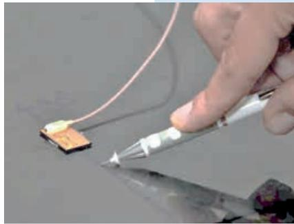
Abb. 2: Bleistiftminenbruch, um eine breitbandige akustische Welle im Prüfobjekt zu erzeugen
