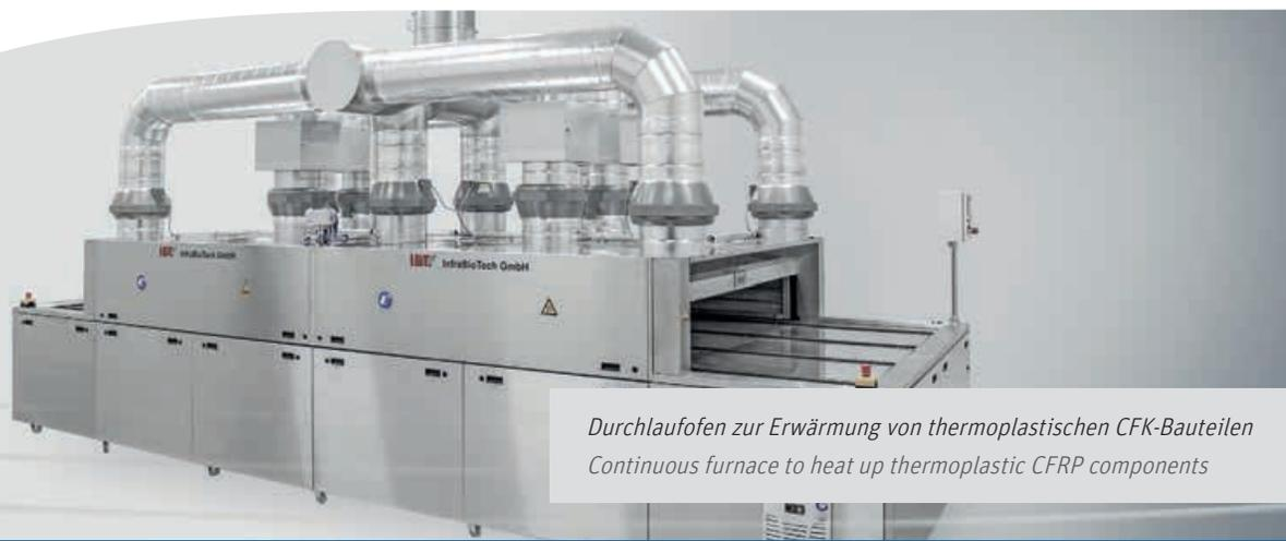
*Durchlaufofen zur Erwärmung von thermoplastischen CFK-Bauteilen
