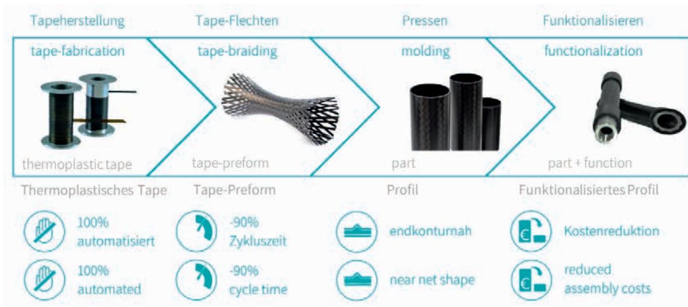
*Herone Technologie für die Herstellung thermoplastischer Faserverbund-Profile
