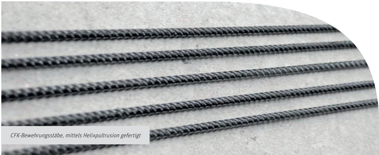
CFK-Bewehrungsstäbe, mittels Helixpultrusion gefertigt
