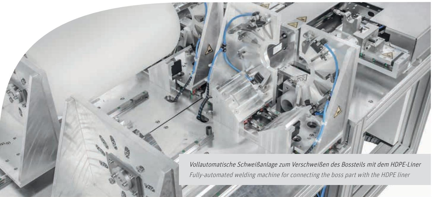
*Vollautomatische Schweißanlage zum Verschweißen des Bossteils mit dem HDPE-Liner
