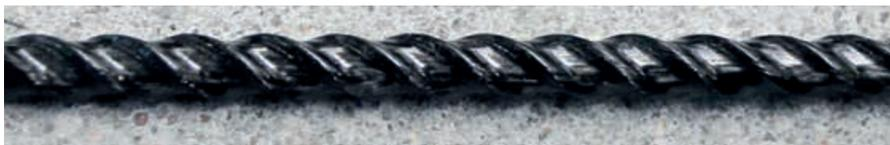
Detailansicht eines mit Helixpultrusion gefertigten CFK-Bewehrungsstabes
