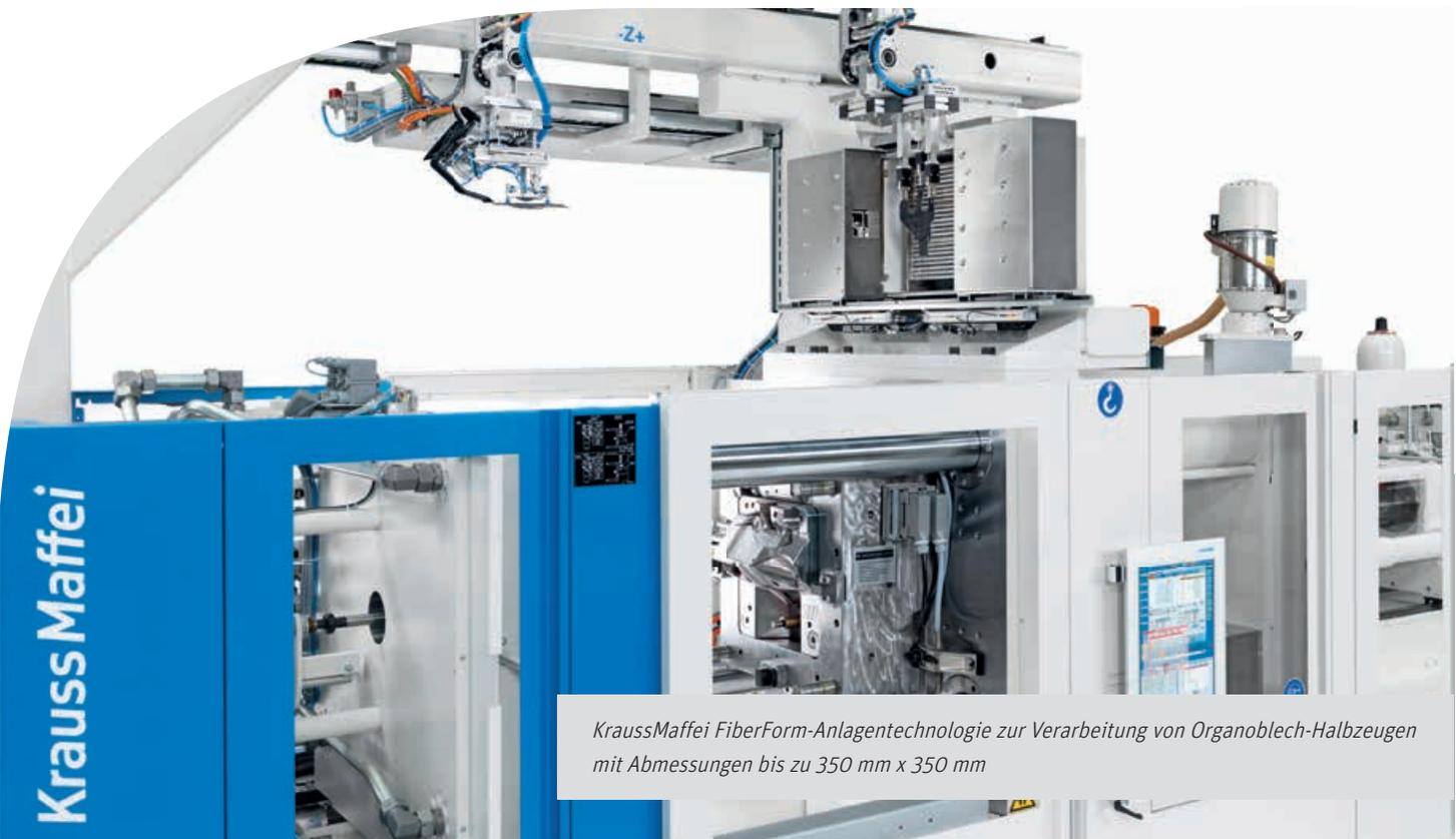
KraussMaffei FiberForm-Anlagentechnologie zur Verarbeitung von Organoblech-Halbzeugen mit Abmessungen bis zu 350 mm x 350 mm
