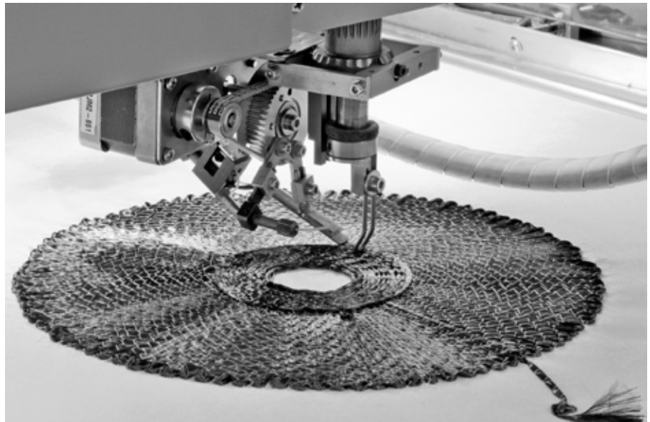
CNC-Legekopf bei der lastpfadgerechten Ablage eines Kohlenstofffaser-Rovings
