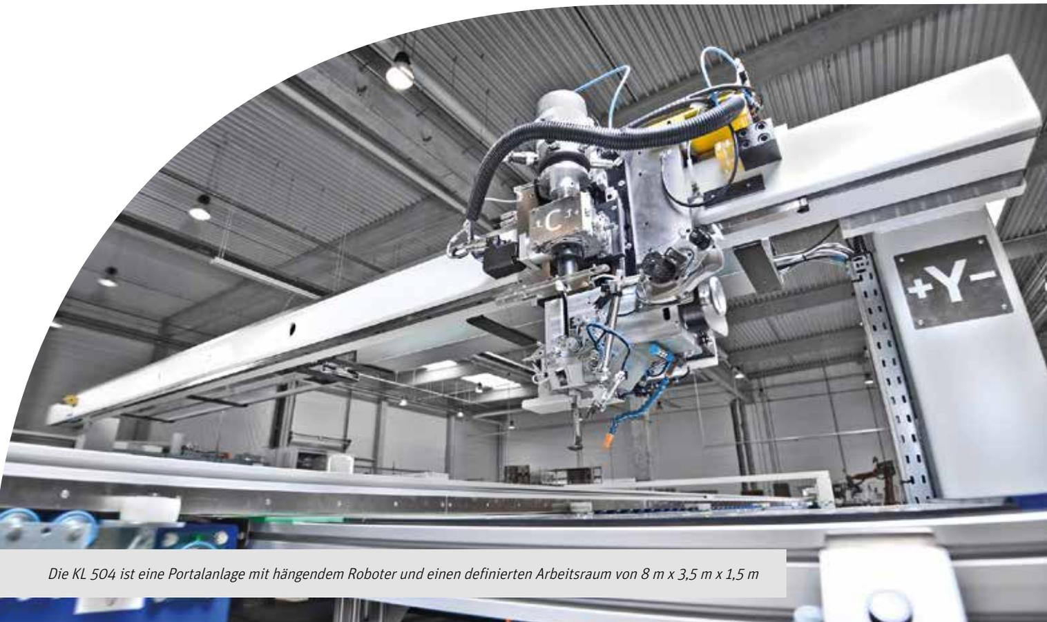
Die KL 504 ist eine Portalanlage mit hängendem Roboter und einen definierten Arbeitsraum von 8 m x 3,5 m x 1,5 m
