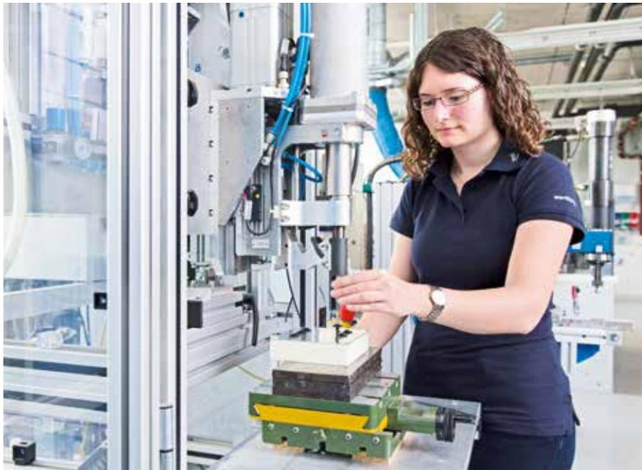
Einbringen spezieller Kunststoffschrauben in Sandwichmaterial
