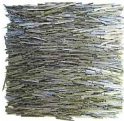
Abb. 3: Quaderförmige Kurzfaser-Preform (ca. 100 x 100 x 5 mm<sup>3</sup>) mit Faservorzugsorientierung
