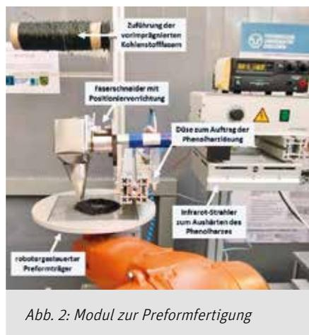
Abb. 2: Modul zur Preformfertigung
