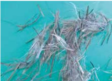
Abb. 1: Carbonfaserrezyklat nach einstufigem Reißprozess
