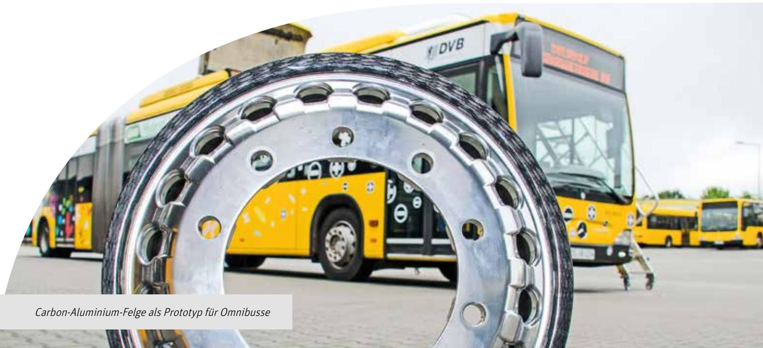
Carbon-Aluminium-Felge als Prototyp für Omnibusse
