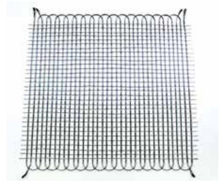
Abb. 2: Manuell gefertigte Musterstruktur mit gegenüberliegenden Schlaufen
