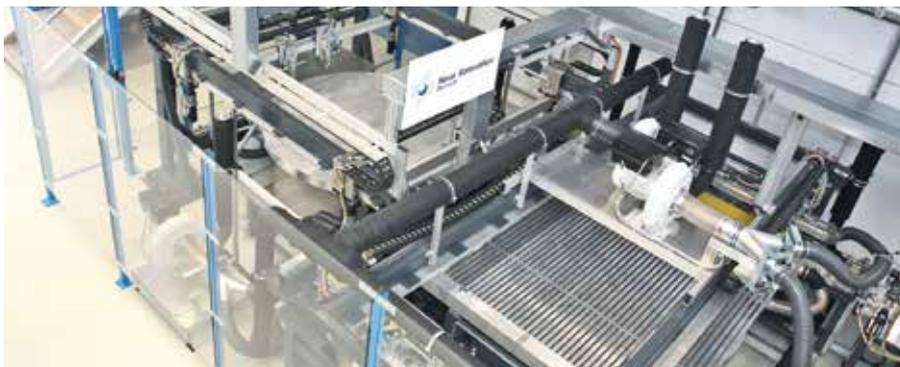
*Multiaxiale Tapelegeanlage – Konzept mit zwei Vakuum-Legetischen*
