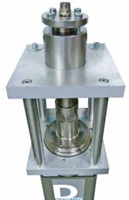
*Prototypen-Mischkopf mit Mischkammer und Ultraschallkonverter*
