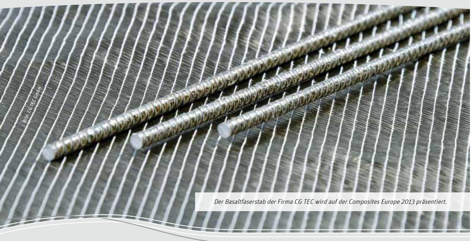
Der Basaltfaserstab der Firma CG TEC wird auf der Composites Europe 2013 präsentiert.
