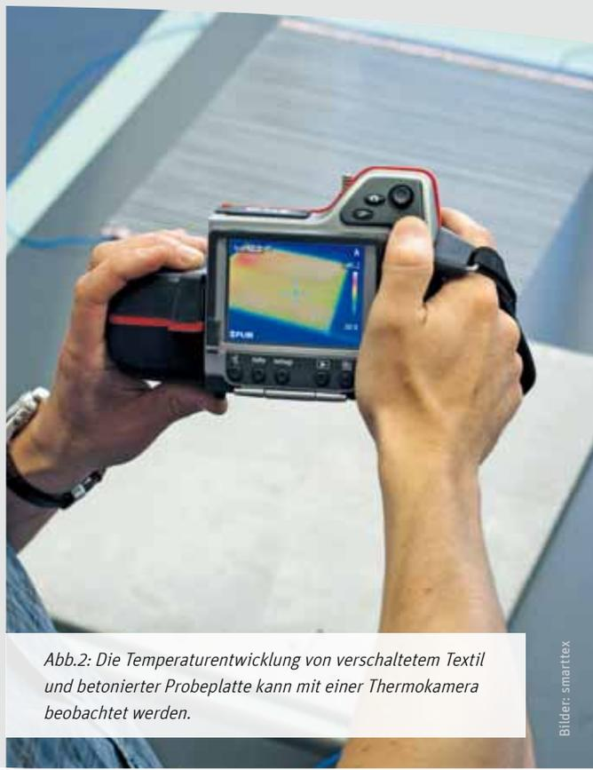
Abb.2: Die Temperaturentwicklung von verschaltetem Textil und betonierter Probeplatte kann mit einer Thermokamera beobachtet werden.
