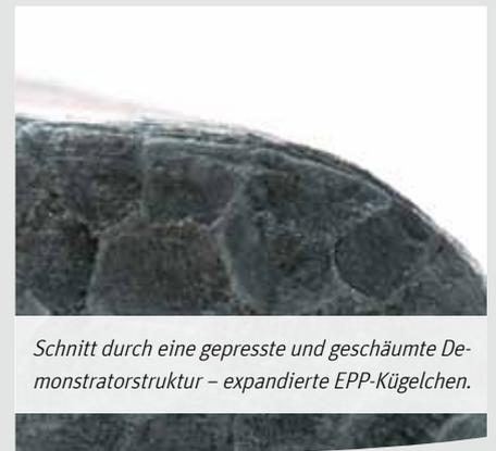
*Schnitt durch eine gepresste und geschäumte Demonstratorstruktur – expandierte EPP-Kügelchen.*
