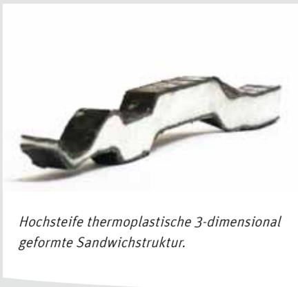
*Hochsteife thermoplastische 3-dimensional geformte Sandwichstruktur.*
