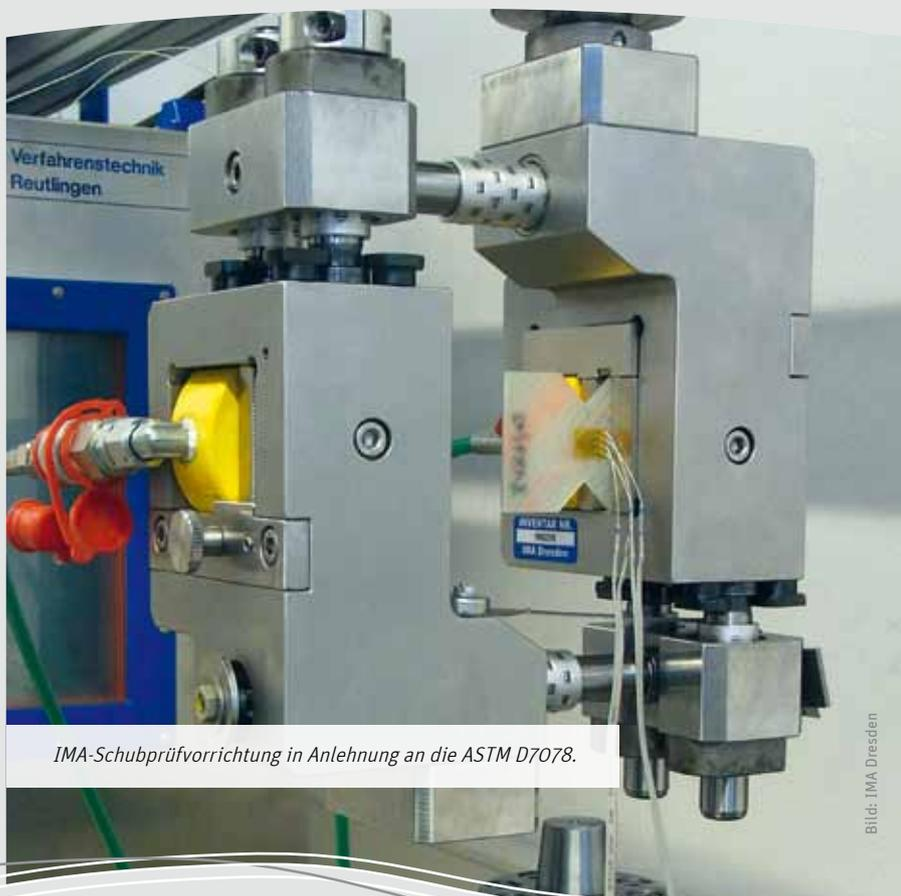
IMA-Schubprüfvorrichtung in Anlehnung an die ASTM D7078.
