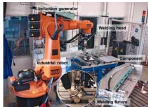
Abb. 2: Kuka-Schweißroboter mit Induktions-Schweißkopf für kontinuierliches Induktionsschweißen.
