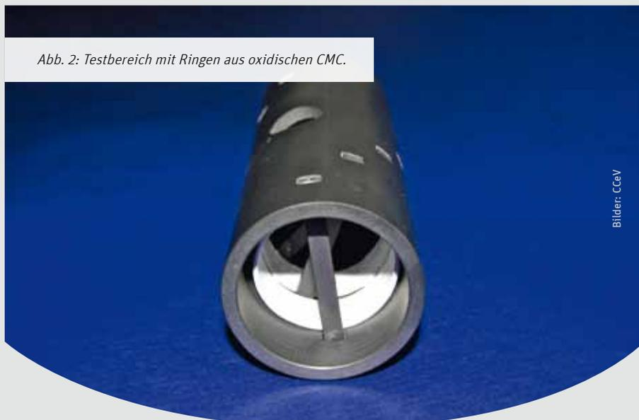
Abb. 2: Testbereich mit Ringen aus oxidischen CMC.
