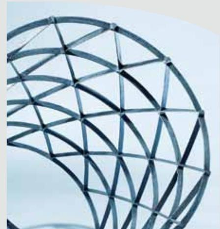
*Kontinuierlich carbonfaserverstärkte Isogrid-Struktur*
