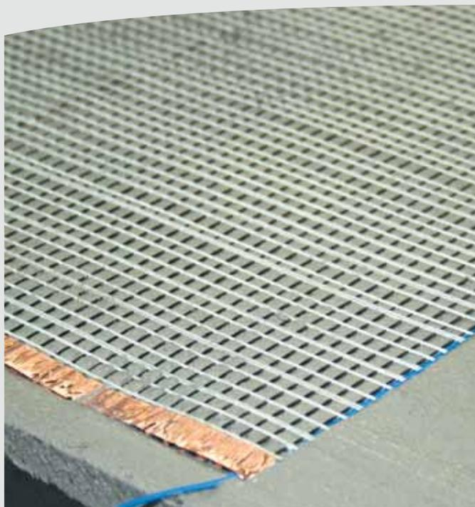
Abb.1: Verschalteter Textilabschnitt bei der Betonage von Probekörpern.
