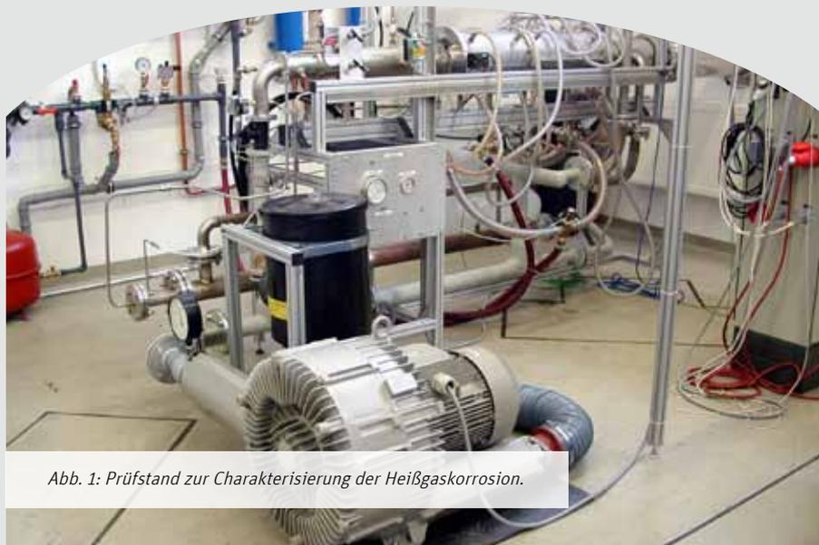
Abb. 1: Prüfstand zur Charakterisierung der Heißgaskorrosion.
