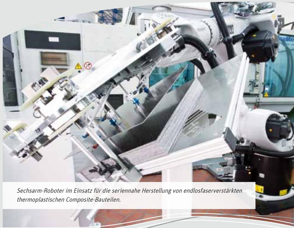
*Sechssarm-Roboter im Einsatz für die seriennahe Herstellung von endlosfaserverstärkten thermoplastischen Composite-Bauteilen.*
