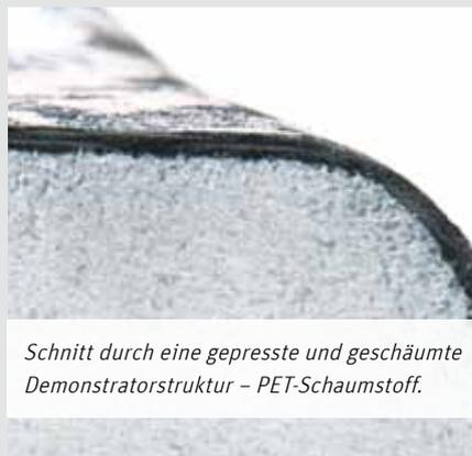
*Schnitt durch eine gepresste und geschäumte Demonstratorstruktur – PET-Schaumstoff.*
