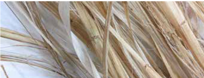
Hanfbaststreifen als Basismaterial für biogene Heavy Tows Strips of hemp bast bark as raw material for biogenic Heavy Tows
