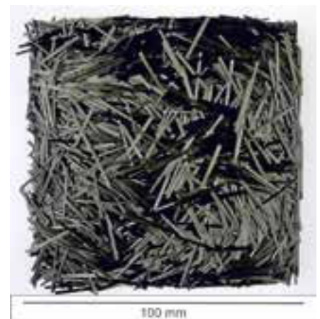
Abb. 2: plattenförmige Kurzfaserverpreform aus Kohlenstofffasern
