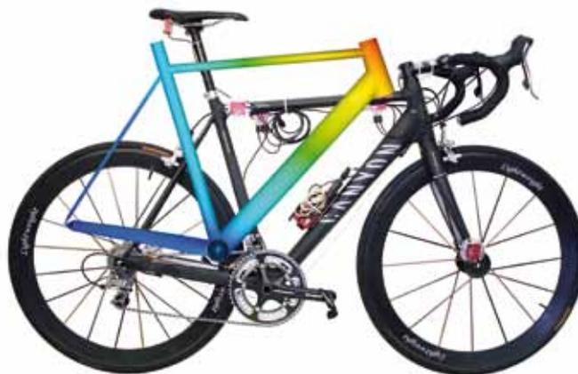
Messfahrrad des IVW mit FE-Bild
