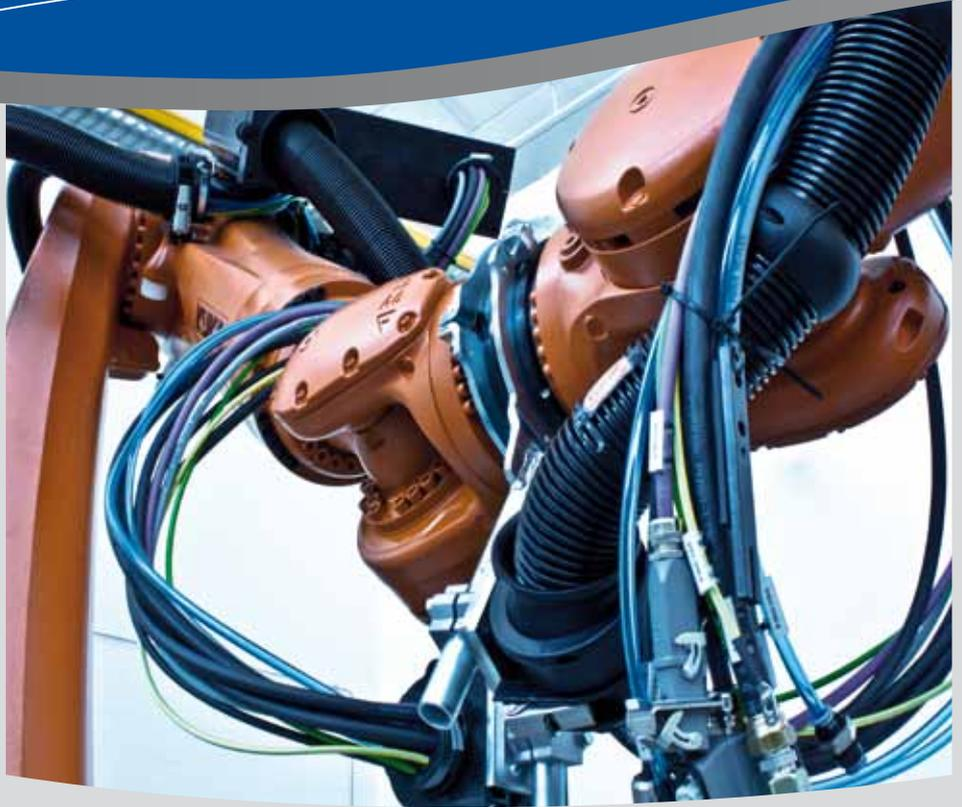
Die am ZLP in Betrieb genommene Roboterzelle besteht aus zwei KUKA-Robotern der neuesten Generation, die auf einer gemeinsamen, fast zehn Meter langen Verfahrachse montiert sind.
