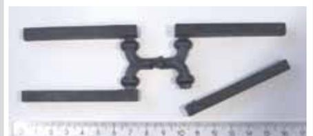
Spritzgegossene Biegebruchstäbe aus Kohlenstoffkurzfasern in einer SiCN-Matrix aus KION ML 33 S66
