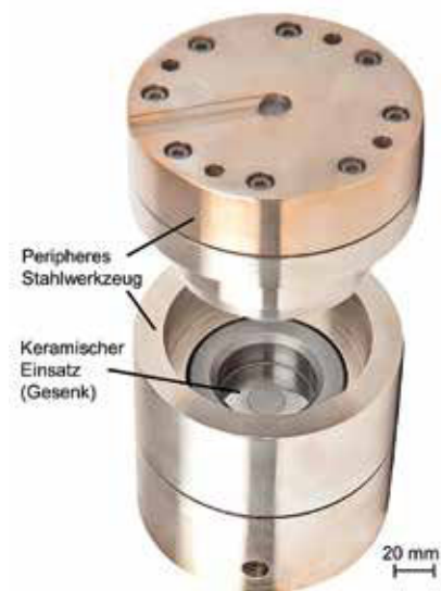
Abb. 2: Werkzeugkonzept „Doppelte Tauchkante“, entworfen und gebaut von Weberit Werke Dräbing GmbH mit Keramikeinsätzen von FCT-Ingenieurkeramik
