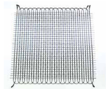
Abb. 2: Manuell gefertigte Musterstruktur mit gegenüberliegenden Schlaufen
