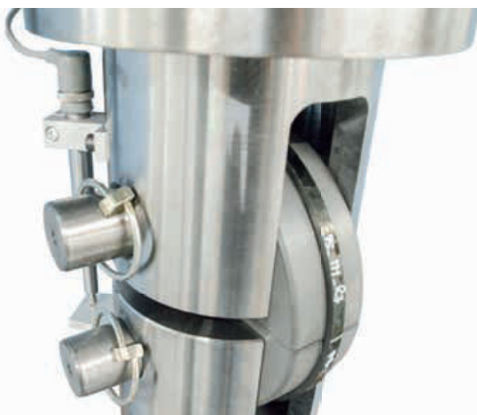
Aufbau zyklische Split-Disk-Prüfung (l.); Ergebnisse der Laminatprobekörper (r.) Test set-up of cyclic split disk-method (l.); test results of filament wound rings (r.)
