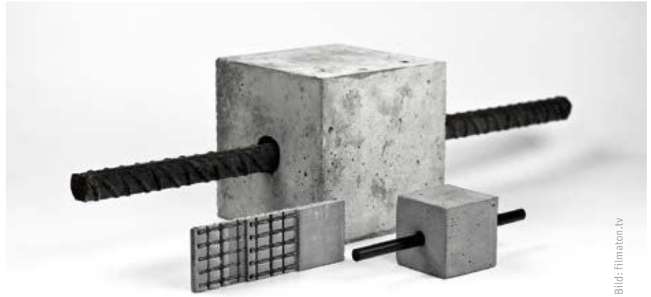
Stahl- und Carbon-Bewehrungsstäbe im Vergleich
