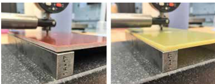
Mit einer PU-Matrix (re.) kann Impact-Energie besser absorbiert werden als mit einer Epoxy-Matrix
