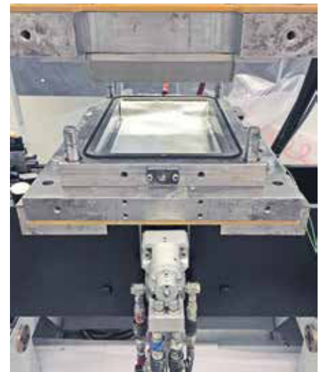
RTM-Werkzeug zur Herstellung der monolithischen Coupon-Probekörper
