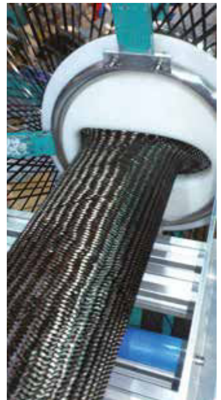
Umflechten der D-Box mit C-Fasern
