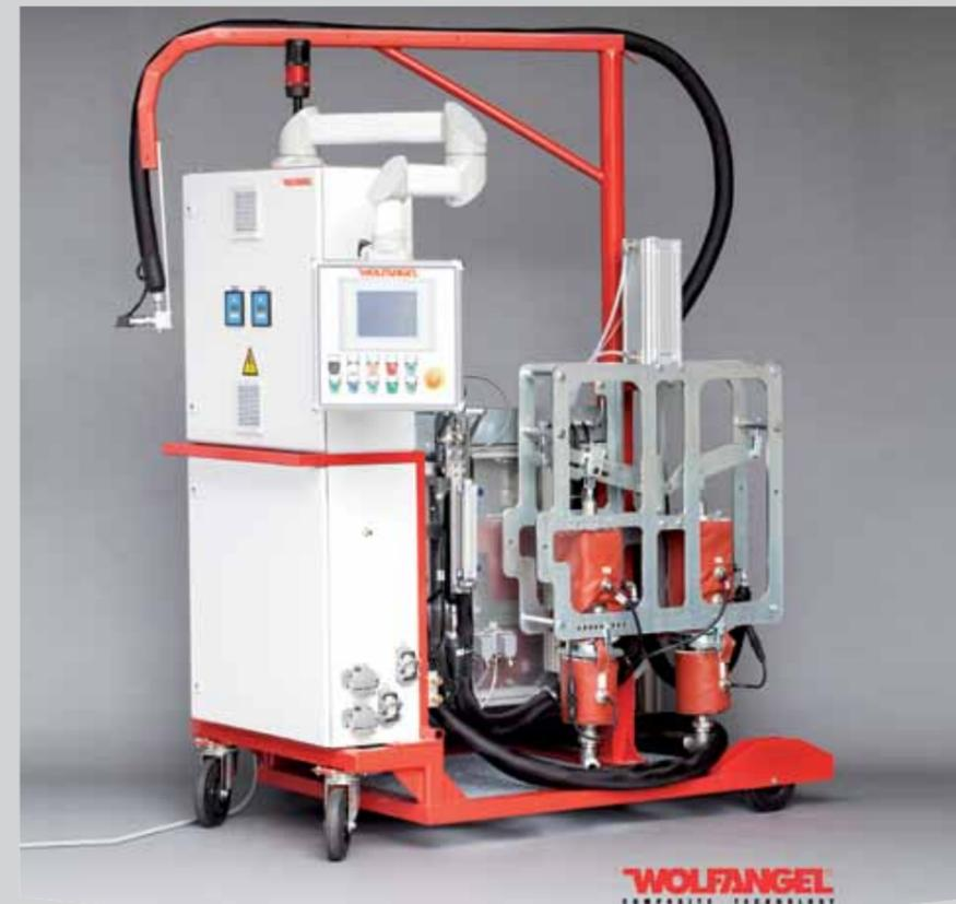
Beheizte Epoxy-Injektionsanlage mit SPS-Steuerung
