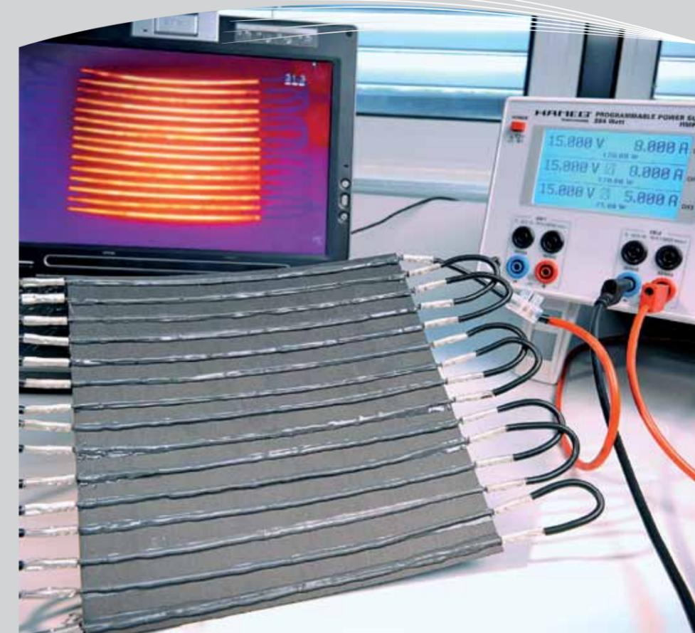
Auf einer Platte aus unidirektional verstärktem CFK sind mehrere Drähte aus einer Formgedächtnislegierung befestigt. Werden diese Drähte von einem elektrischen Strom durchflossen erwärmen sie sich, wie es auf dem Bild der Thermokamera zu sehen ist. Die Temperaturänderung führt zu einer durch die Mikrostruktur hervorgerufenen Längenänderung des Drahtes (ca. 2 – 3 %). Diese Längenänderung reicht aus, um die gesamte Platte zu deformieren.
