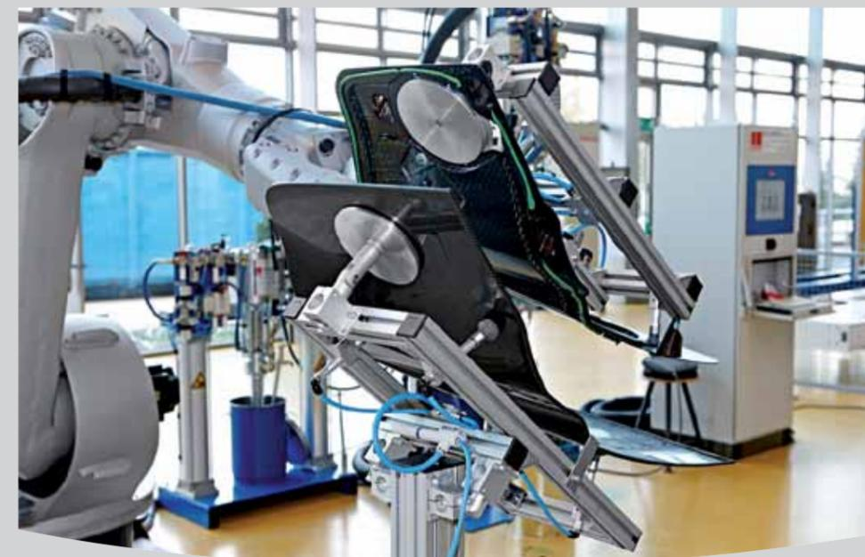
Automatisiertes Verkleben und Fügen einer CFK-Baugruppe mit 2K
