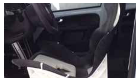
Abb. 2: Einschalige Sitzstruktur für das „50. Perzentil Frau“, eingebaut im VW Up
