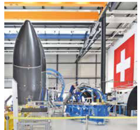
Die Nutzlastverkleidung an der Spitze verleiht einer Trägerrakete ihre typische aerodynamische Form.
