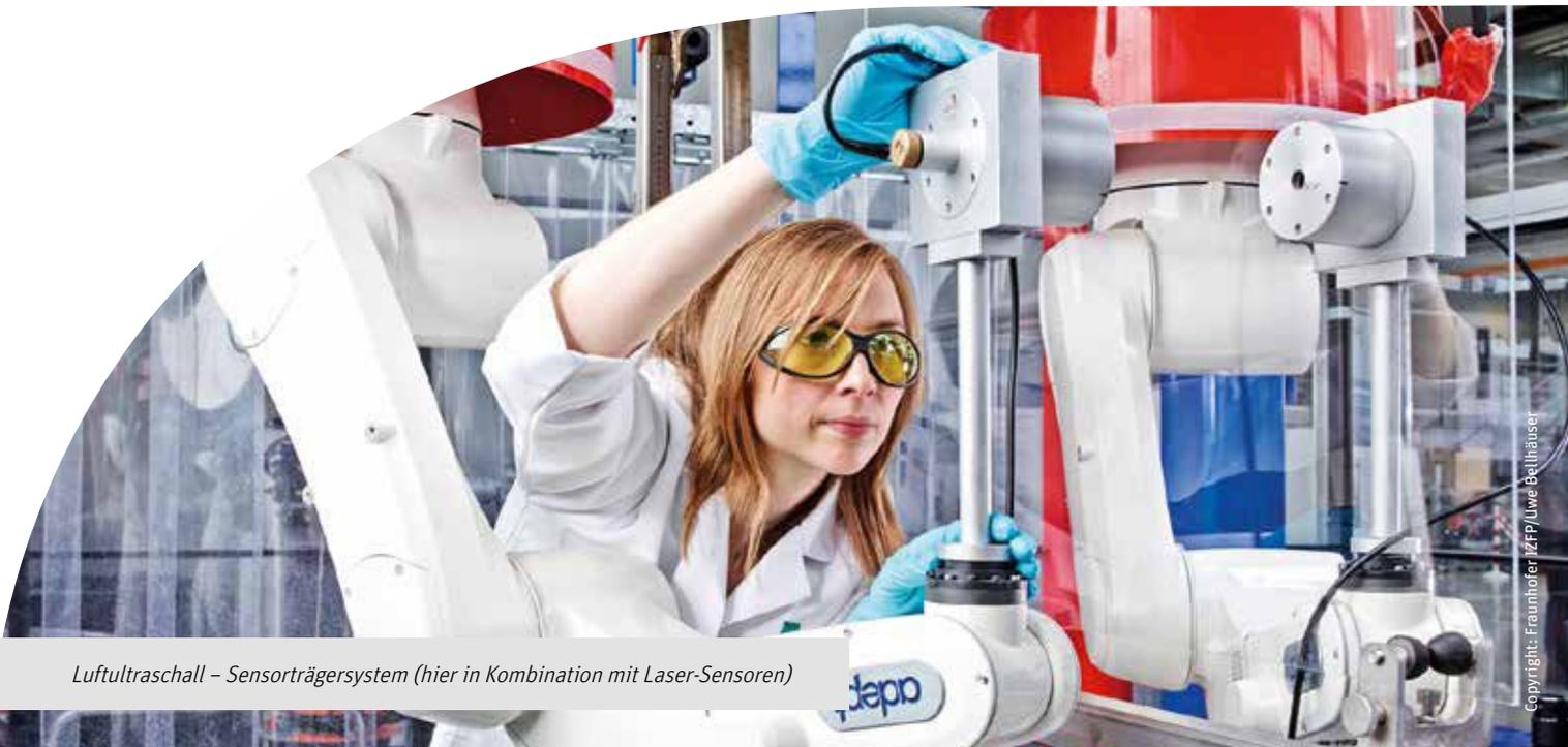
Luftultraschall – Sensorträgersystem (hier in Kombination mit Laser-Sensoren)
