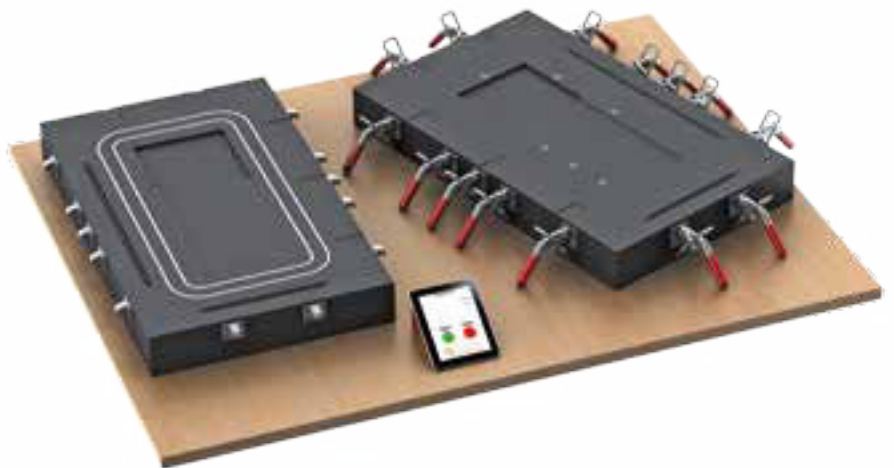
Qpoint Composite liefert aktives CFK-RTM-Werkzeug mit Prozesssteuerung für Prototypen und Kleinserien
