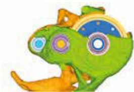
Topologieoptimierung zur Identifizierung der Lastpfade
