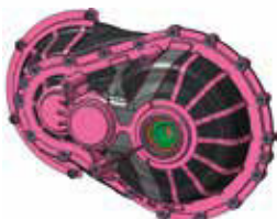
Organosheet-Getriebegehäuse, umspritzt mit einem faserverstärkten Thermoplast und mit applizierten UD-Tapes
