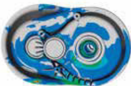
FE-Berechnung zur Prüfung der Gehäusesteifigkeit und -festigkeit
