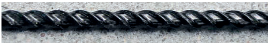
Detailansicht eines mit Helixpultrusion gefertigten CFK-Bewehrungsstabes
