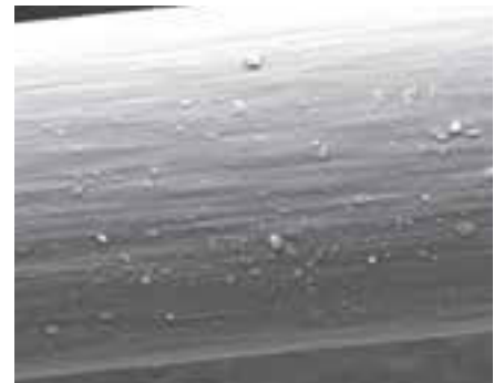
Faseroberfläche nach der Präparation mit Monomerenlösung
