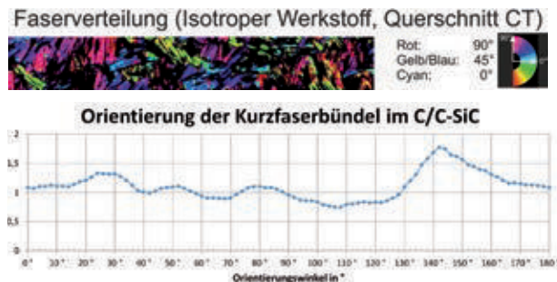
Abb. 1: Bestimmung der Faserverteilung im Volumen einer Biegeprobe (90 mm x 9 mm x 6 mm). Oben: CT-Querschnitt einer Probe mit farbkodierter Faserorientierung; Unten: Histogramm mit der quantitativen Bestimmung der Faserbündelorientierung im gesamten Probenvolumen
