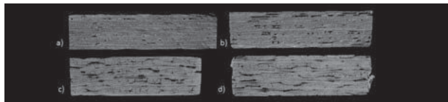
Abb. 2: Einfluss der Trennverfahren auf den Probenquerschnitt: a) Nasstrennschleifen mit senkrechtem Seitenschnitt; b), c) Wasserstrahlschneiden mit etwa 5° Neigung der Flanken; d) Laserstrahlschneiden mit ungleichmäßiger und stark beschädigter Flanke durch Wärmeeintrag. a) und b) zeigen einen anderen Komposit als c) und d).
