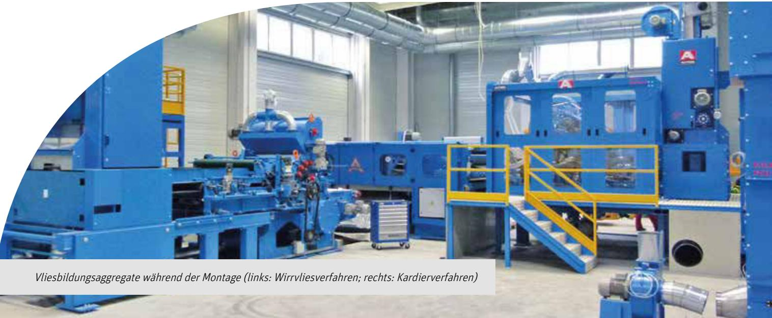
Vliesbildungsaggregate während der Montage (links: Wirrvliesverfahren; rechts: Kardiervverfahren)
