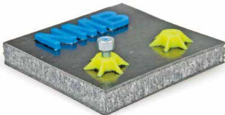
Abb. 1: 3D-Druck-Demonstrator mit aufgedruckten Funktionselementen
