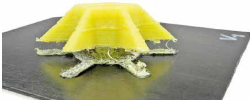
Abb. 2: Versagen Schraubdom im Test
