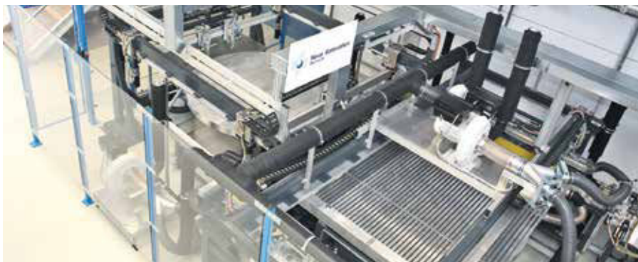
Multiaxiale Tapelegeanlage – Konzept mit zwei Vakuum-Legetischen
